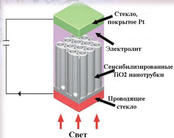
Рис.6.29. Схема фотоэлектрических солнечных ячеек с TiO 2 нанопроволоками (слева) и фото наноматериала на их основе (справа)
