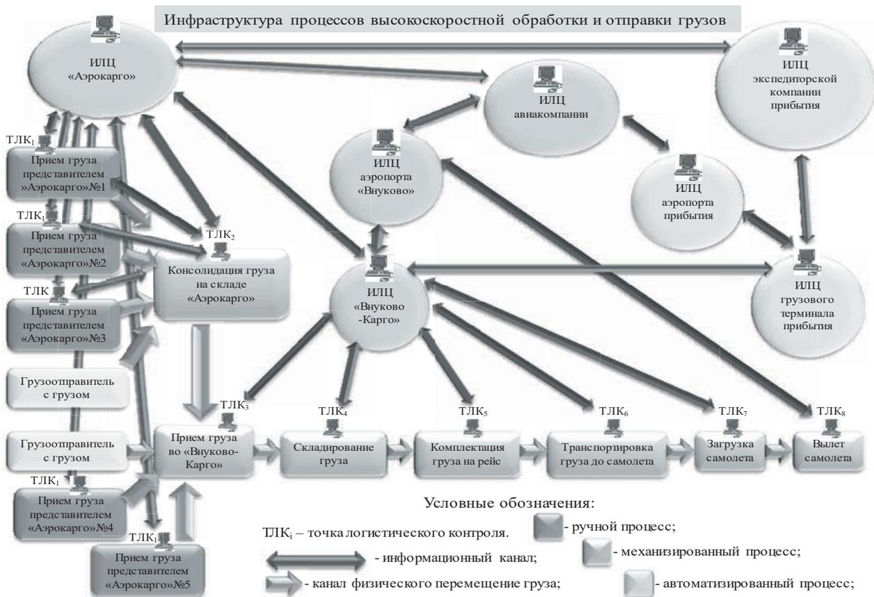
**Рис. 2. Сложная организационно-техническая система транспортно-логистического терминала (центра) со смешанной моделью обработки и доставки грузов**
