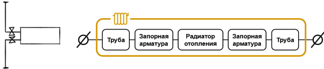
Рис. 2. Схема замещения системы подключения одного радиатора отопления
