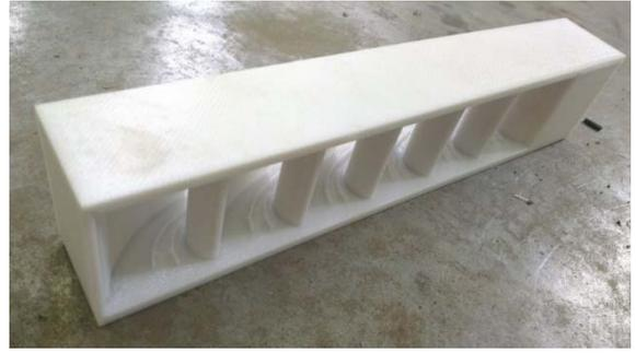
Рисунок 3.5 – Плоская модель сопловой турбинной решетки
