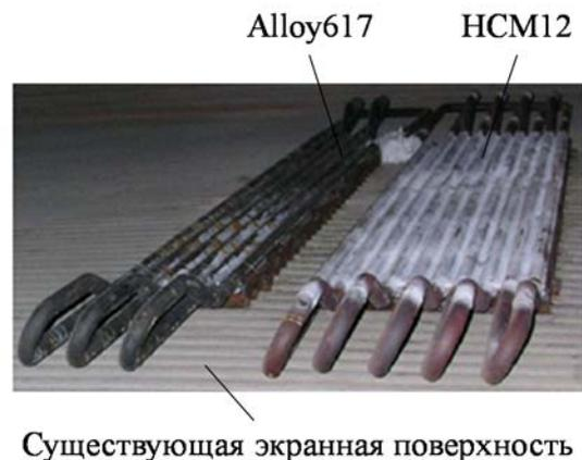
Рисунок 1.8 – Опытная панель из стали 617 и стали HCM12
