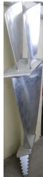
Рисунок 3.63 – Электронная модель и изготовленный на станке с ЧПУ демонстрационный образец «вилочной» рабочей лопатки
