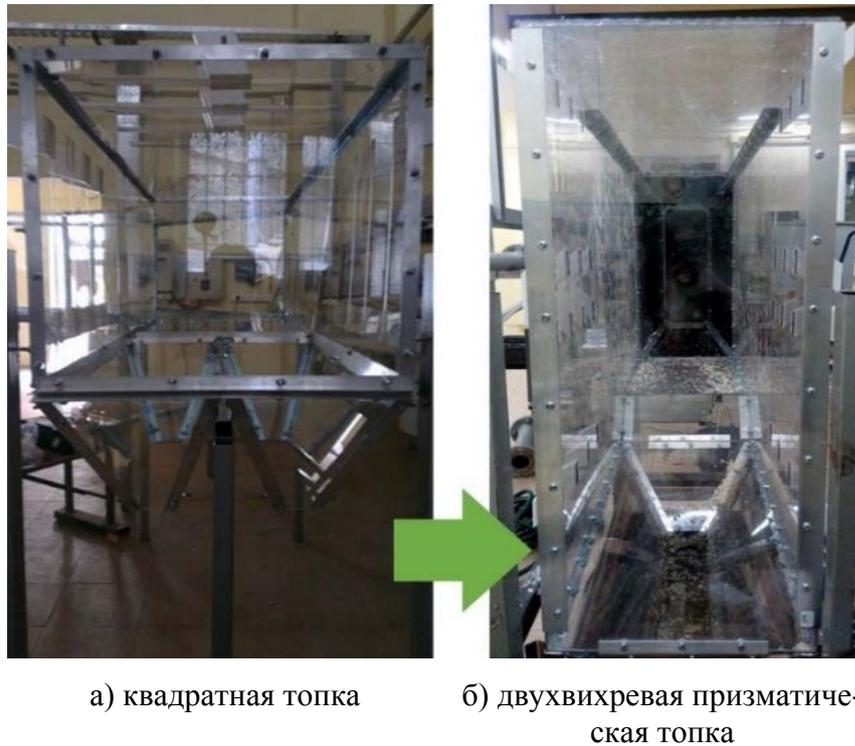
Рисунок 3.53 – Модели горизонтальных топок
