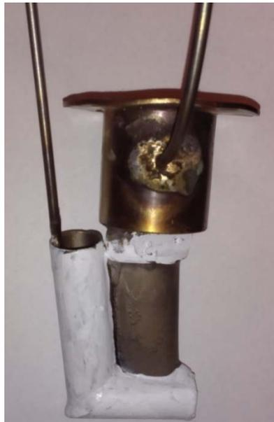
Рисунок 4.23 – Препарированная для испытаний лопатка
