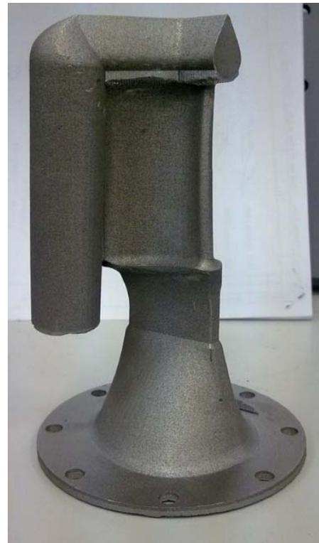
Рисунок 4.17 – Прототип лопатки, изготовленный по SLM-технологии
