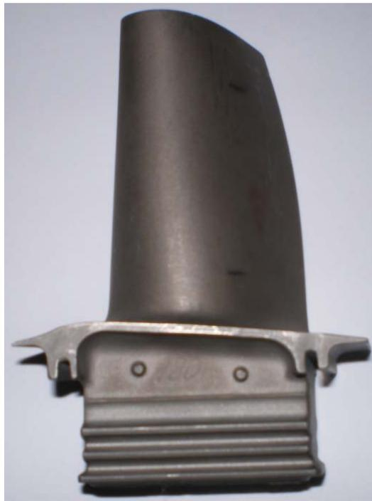
Рисунок 4.15 – Рабочая лопатка газотурбинной установки, изготовленная по серийной технологии
