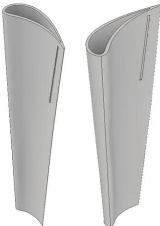
Рис. 13. 3D модель полый сопловой лопатки последней ступени ЦНД
