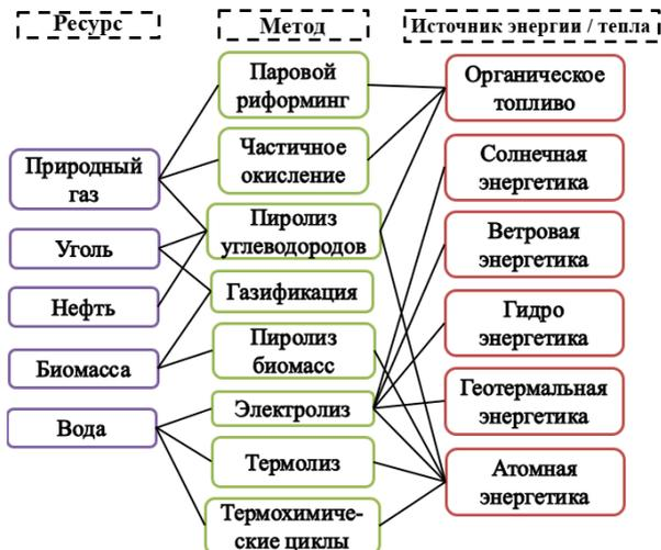
Рис 1. Методы производства водорода
