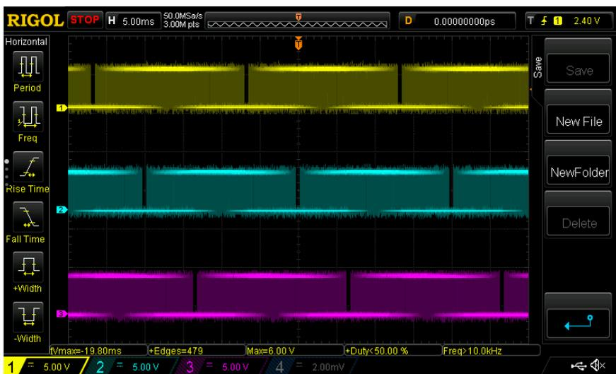
Рис. 6. Осциллограммы ШИМ сигнала верхних ключей разработанного конвертора фаз А (желтый), В (синий), С (фиолетовый)
