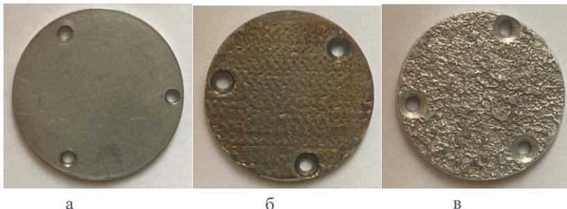
Рис. 6. Образцы пластин: а) гладкая поверхность, б) поверхность лазерной обработки, в) поверхность, обработанная плазмой
