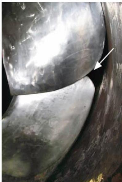
Рис. 2. Щели между лопастями РК и неподвижными частями ПЛ-турбины
