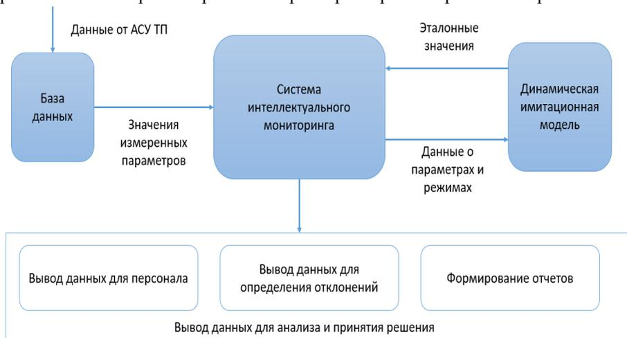
Рис. 1. Структурная схема цифрового двойника
