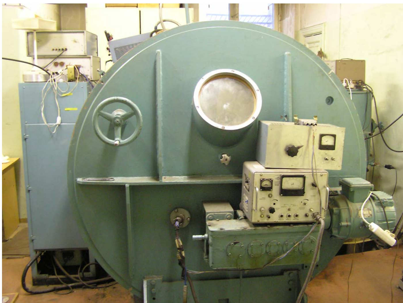
Электронно-лучевая установка «Луч-1» мощностью 15 кВт
