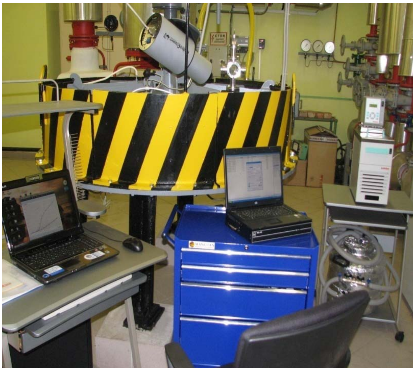
Экспериментальный стенд для исследования процесса высокоскоростного взаимодействия жидких частиц с твердой поверхностью и определения эрозионной стойкости конструкционных материалов и защитных покрытий
