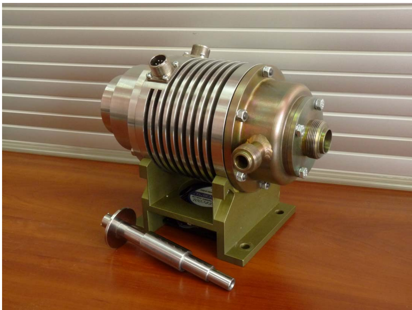
Турбогенератор работающий в органическом цикле Ренкина ( P = 1 кВт, n = 100\,000 об/мин) разработки кафедры ЭКАО
