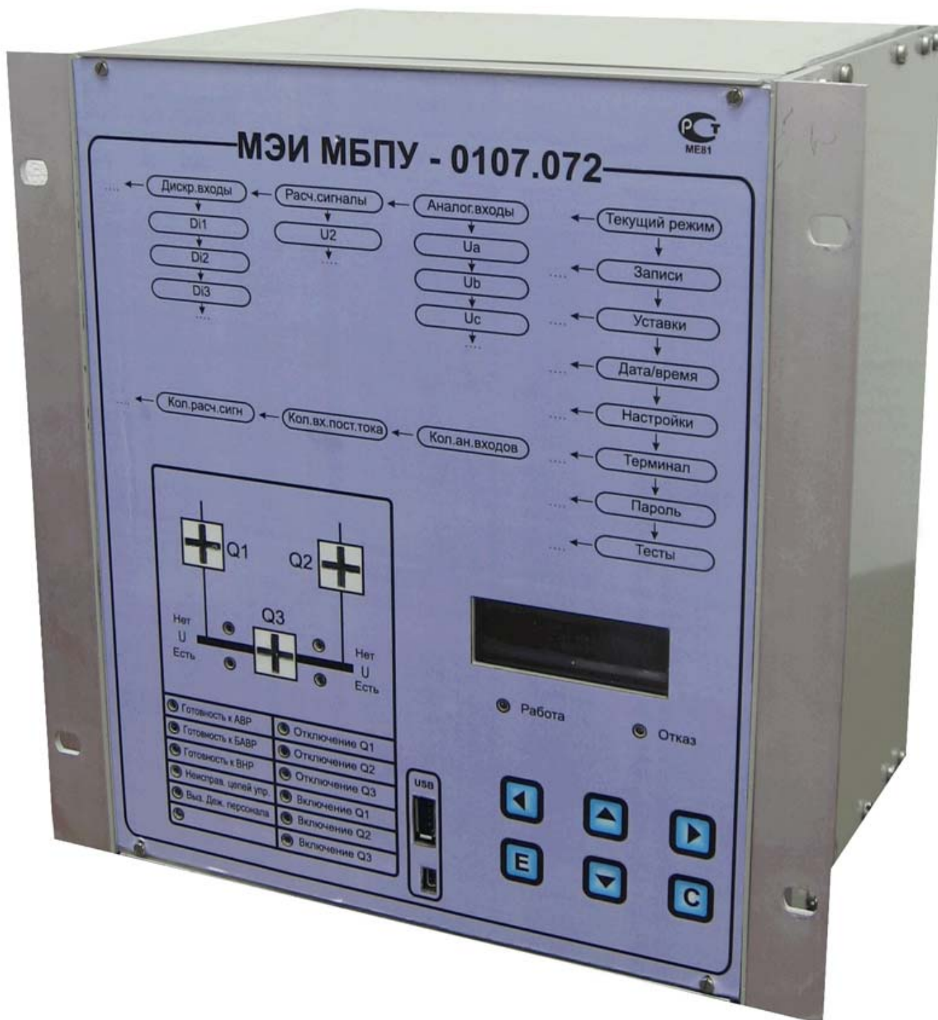
Терминал пускового устройства быстродействующего автоматического включения резервного питания (БАВР) разработки кафедры ЭПП
