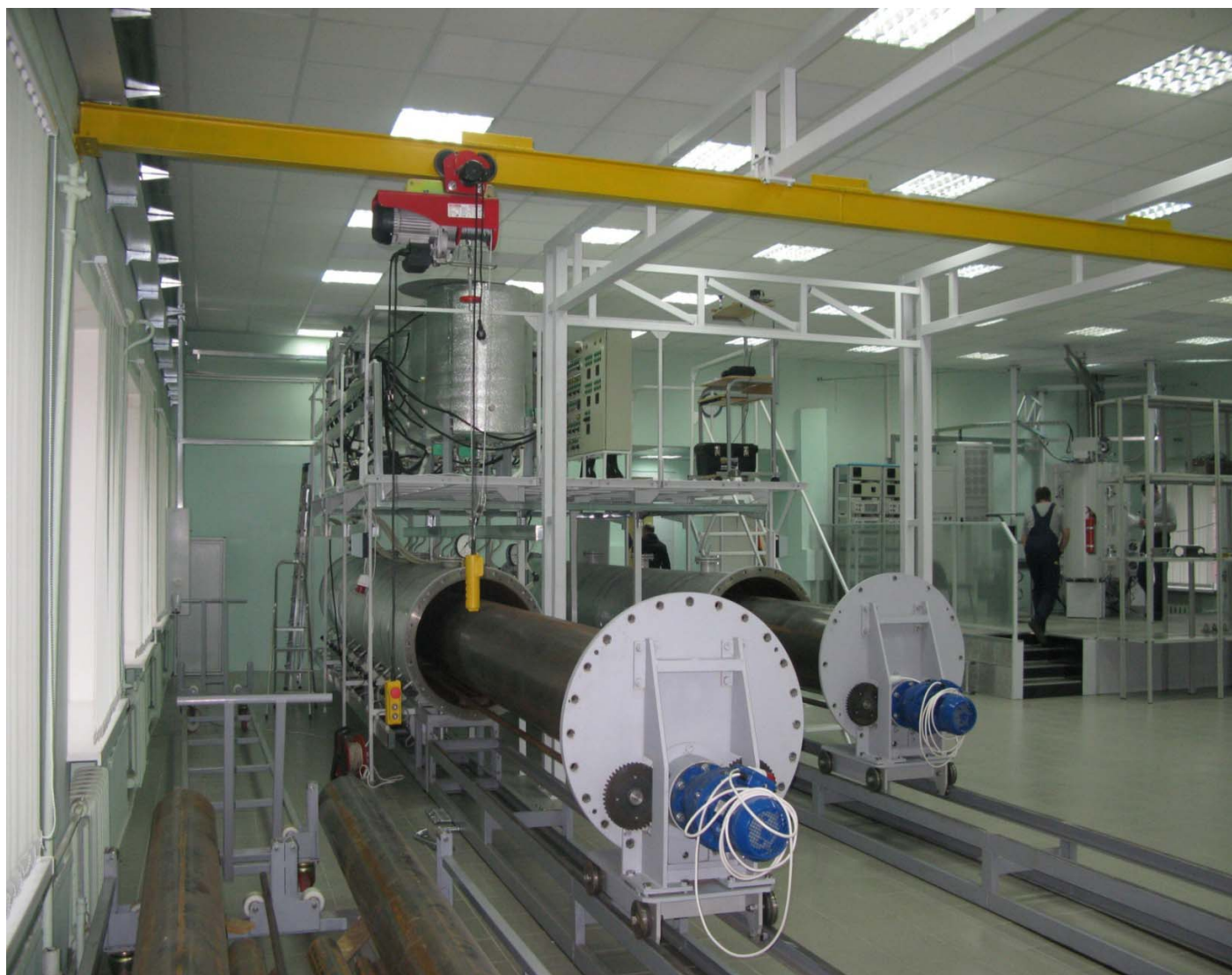
Установка для модификации трубных поверхностей с использованием ПАВ технологий
