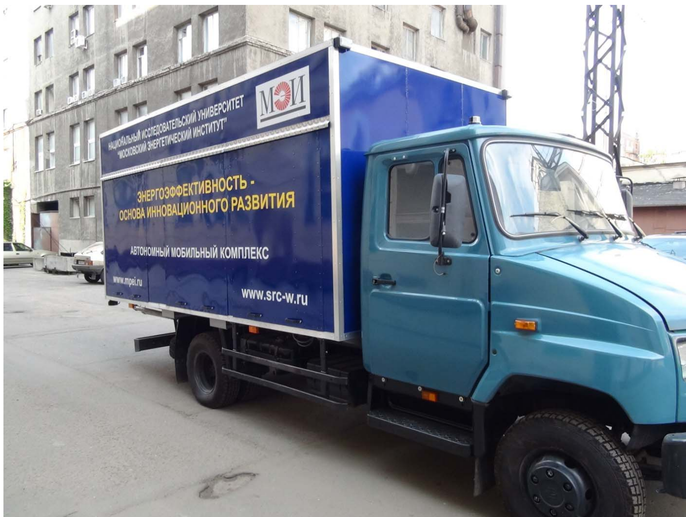
Автономный мобильный комплекс для повышения эффективности систем теплоснабжения на основе модификации внутритрубных поверхностей с использованием ПАВ-технологий
