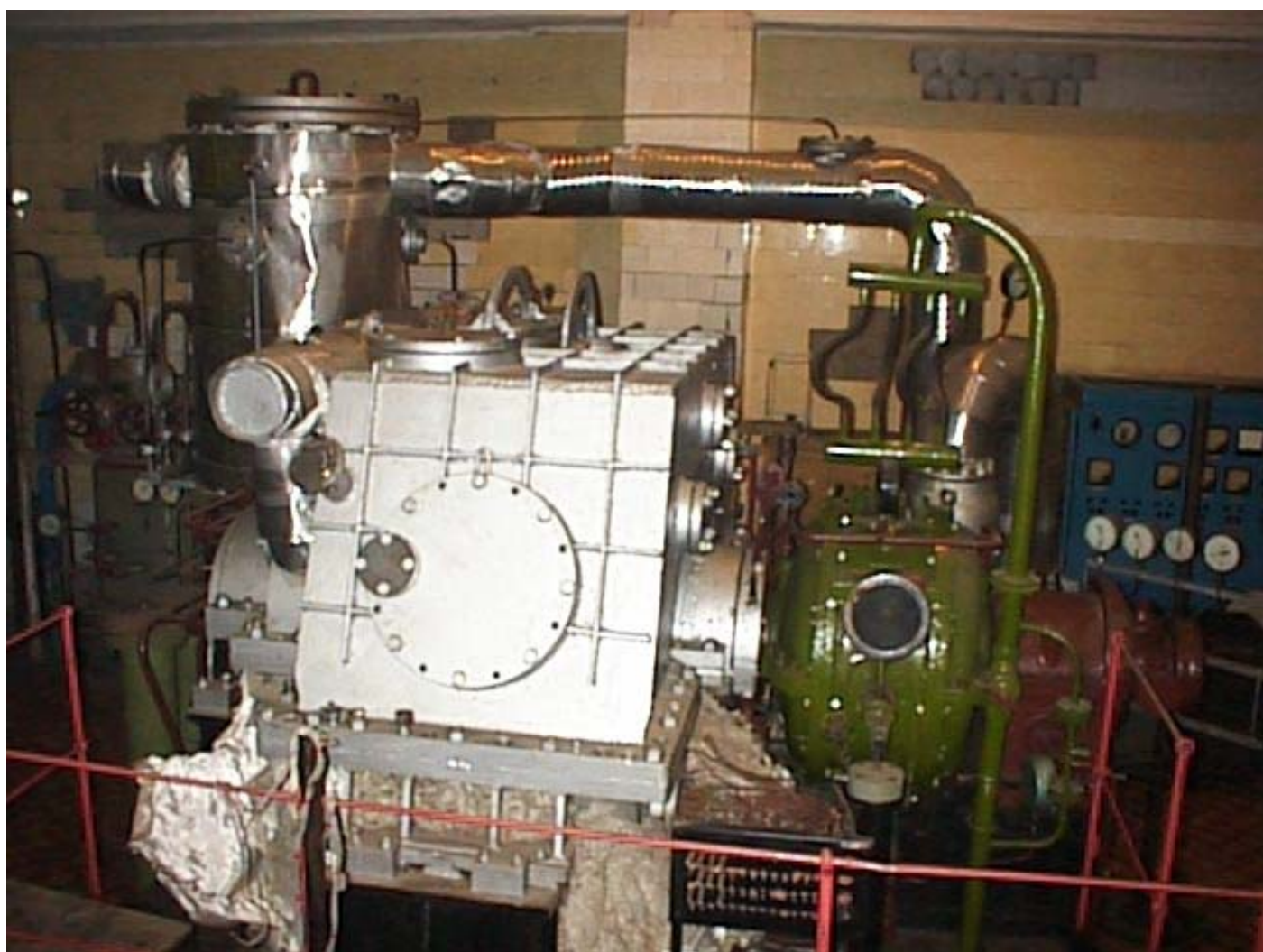
Экспериментальная турбина для исследования течения влажного пара в ЦНД мощных паровых турбин
