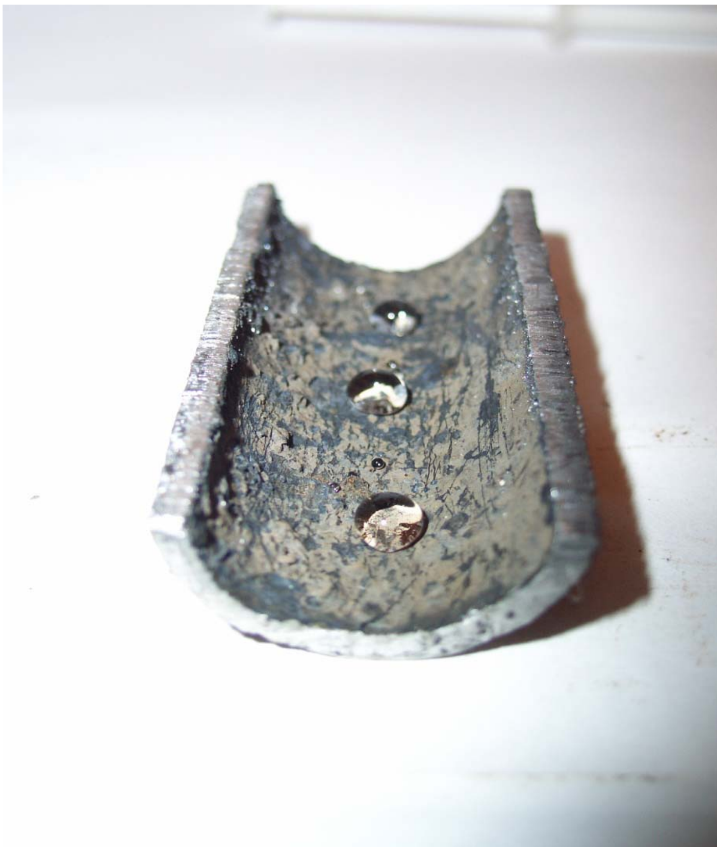
Гидрофобность внутренней поверхности вырезанного образца трубы конвективного пучка котла ПТВМ-50 после применения ПАВ-технологии
