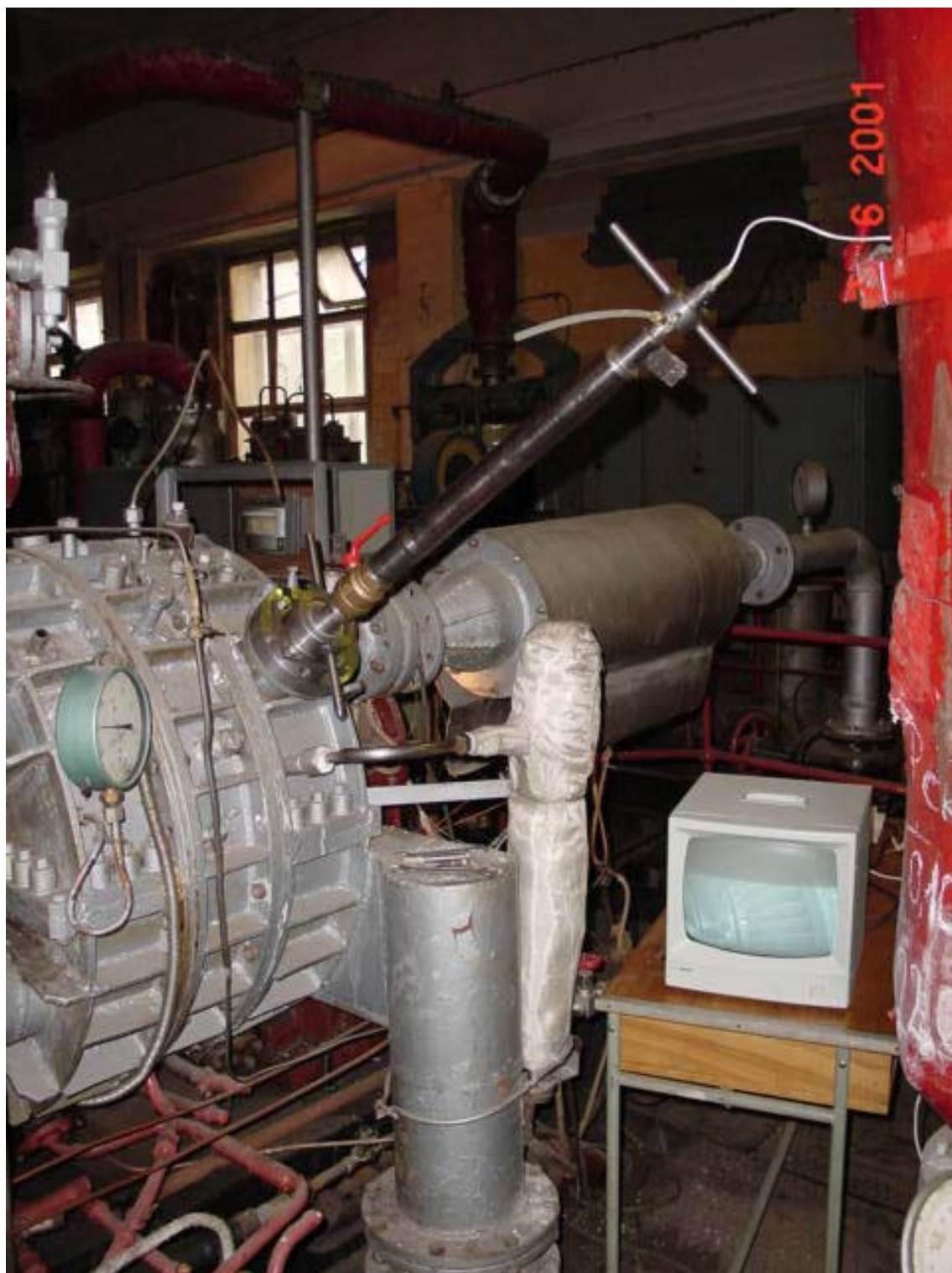
Экспериментальная турбина для исследования профилей сопловых и рабочих лопаток влажнопаровых турбин
