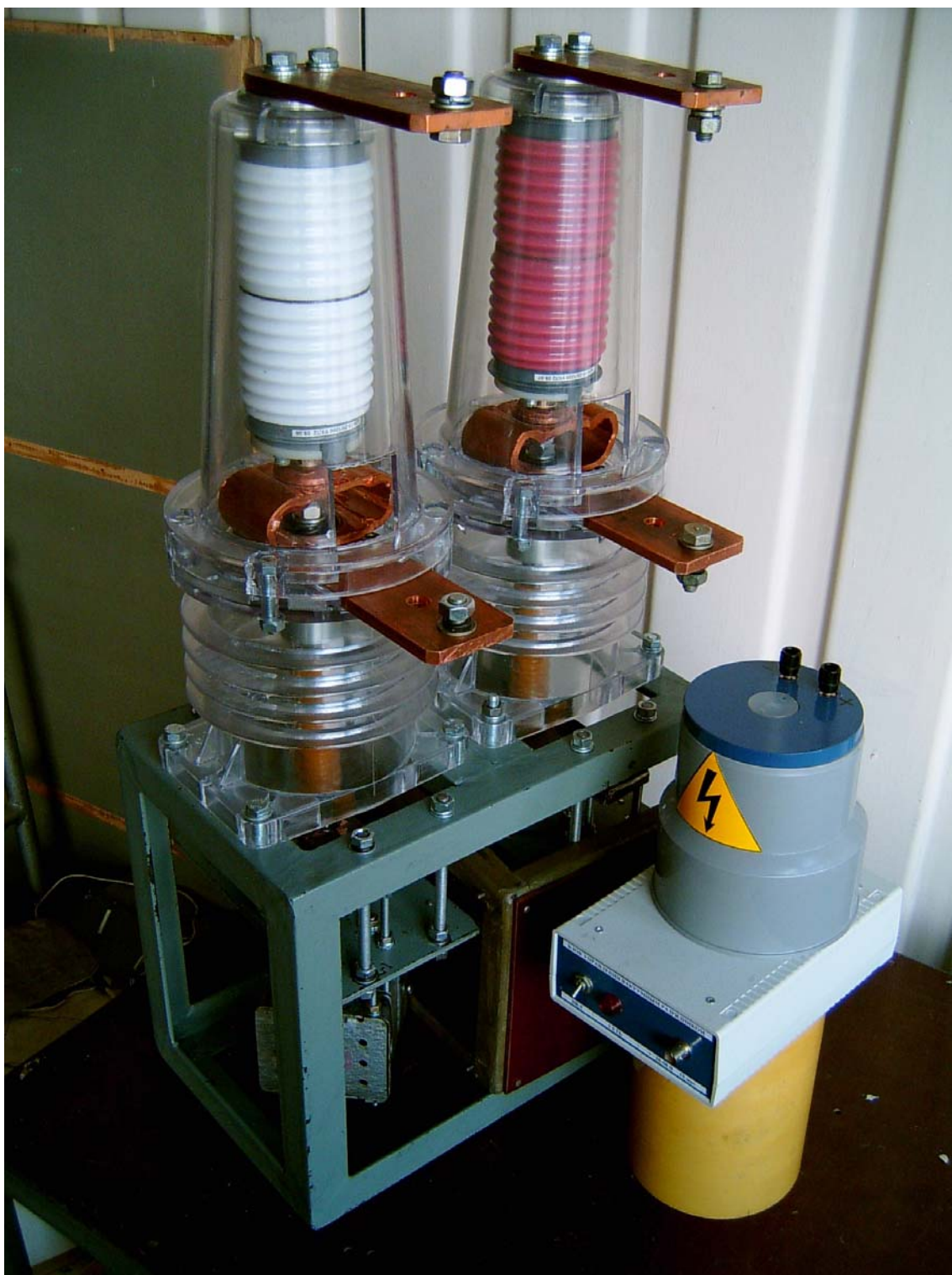
Вакуумный выключатель с модернизированной катодной системой, каф. ЭиЭА
