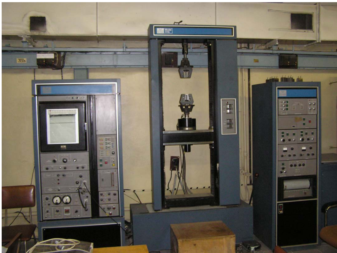
Универсальная испытательная машина Instron для определения механических свойств конструкционных материалов
