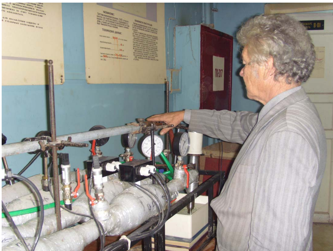
Экспериментальный стенд для исследования интенсификации процессов тепло- и массообмена
