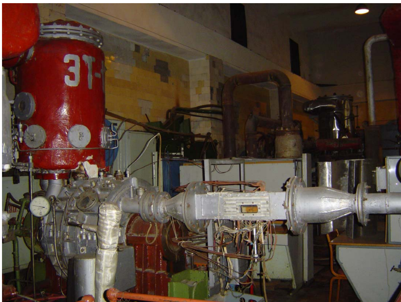
Стенд для исследования течения влажного пара на базе экспериментальной турбины ЭТ-12
