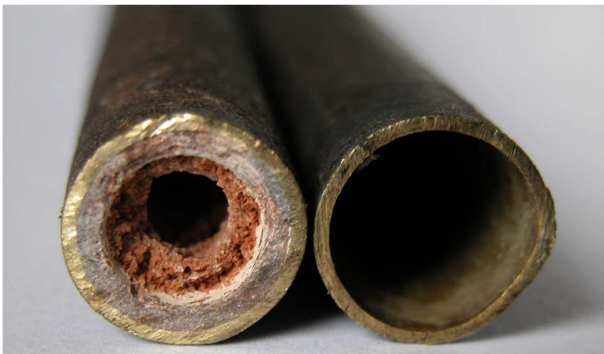
**до** применения очистки и пассивации      **после** применения очистки и пассивации
