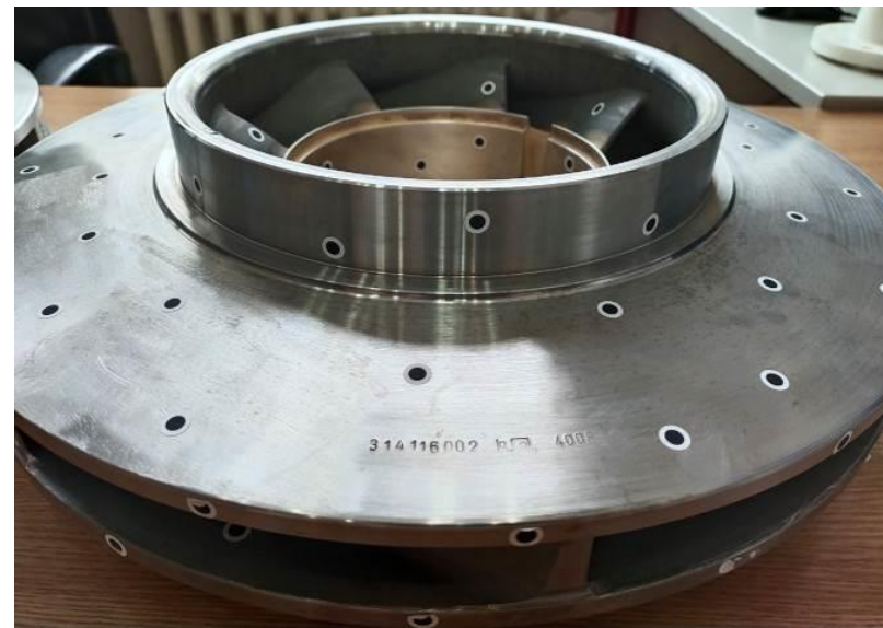
Исходное рабочее колесо с метками для 3D сканирования
