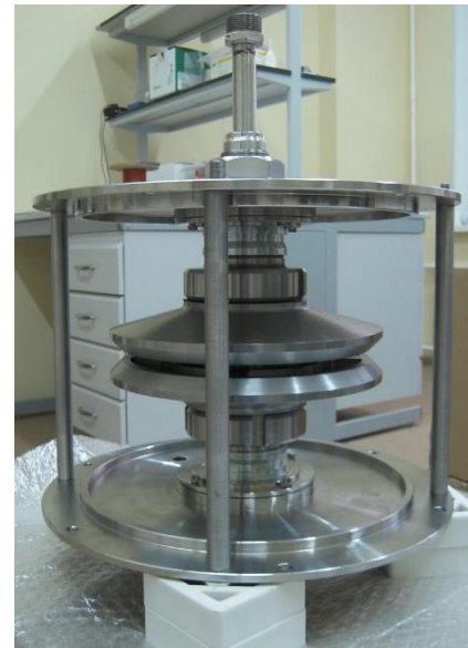
Экспериментальный образец накопителя энергии 30 кДж, 2 кВт
