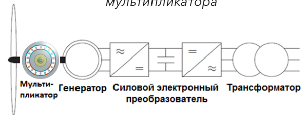
Пример компоновки ВЭУ с магнитным мультипликатором
