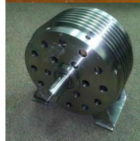
Экспериментальный образец магнитного мультипликатора
