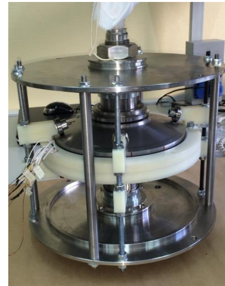
Экспериментальный образец накопителя энергии 30 кДж, 2 кВт
