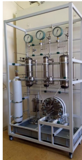
Лабораторный стенд для исследования процессов щелочного электролиза
