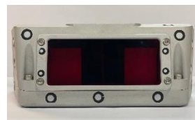
Сканер профиля вымени представляет собой четырех полосный лидар, реализованный на базе вращающегося зеркала
