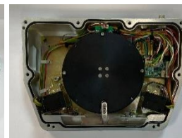
Сканер профиля вымени представляет собой четырех полосный лидар, реализованный на базе вращающегося зеркала
