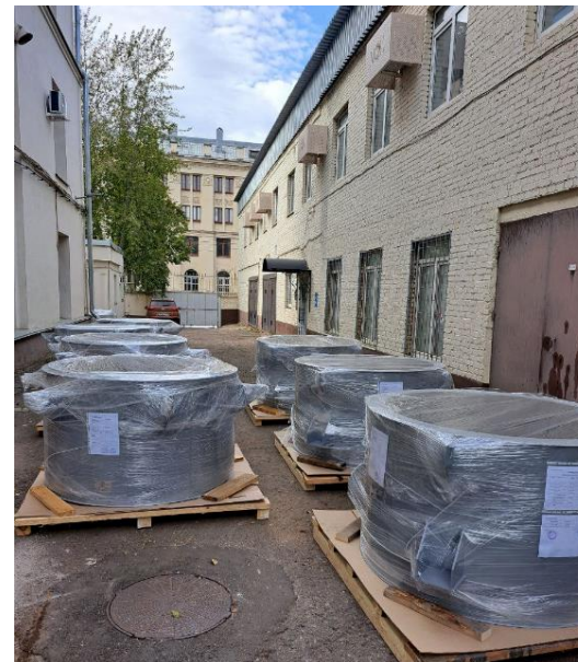
Модули глушителей шума выброса пара, изготовленные на ОПЗ МЭИ
