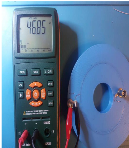
Измерение параметров возбуждающей и приемной катушек преобразователя
