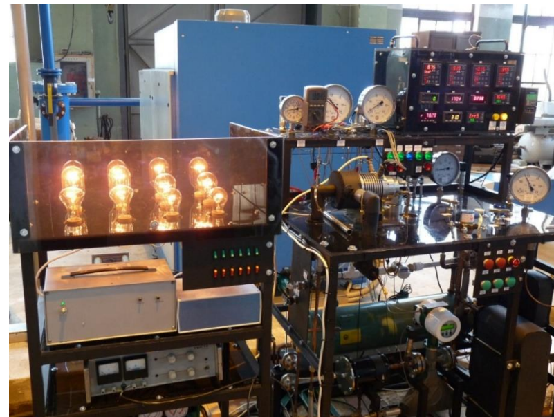
Стендовые испытания образца прототипа энергоустановки по утилизации теплоты выхлопных газов автомобилей, работающей по органическому циклу Ренкина
