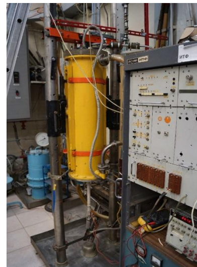
Экспериментальный стенд для исследования гидродинамики и теплообмена жидкого металла в продольном магнитном поле.
