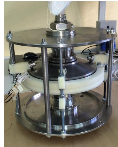
Экспериментальный образец накопителя энергии 30 кДж, 2 кВт
