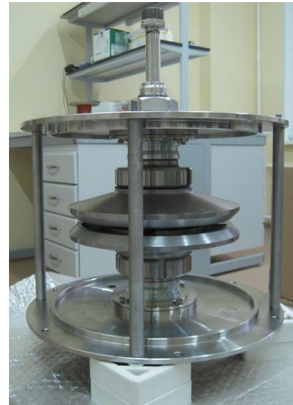
Экспериментальный образец накопителя энергии 30 кДж, 2 кВт
