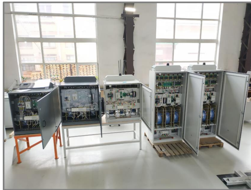
Разработка и производство полупроводниковых устройств стабилизации переменного напряжения мощностью 50-100-160-200 кВт
