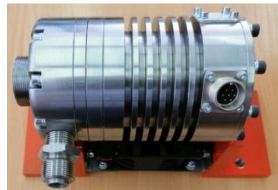
Образцы и 3D-модель высокоскоростных турбогенераторов
