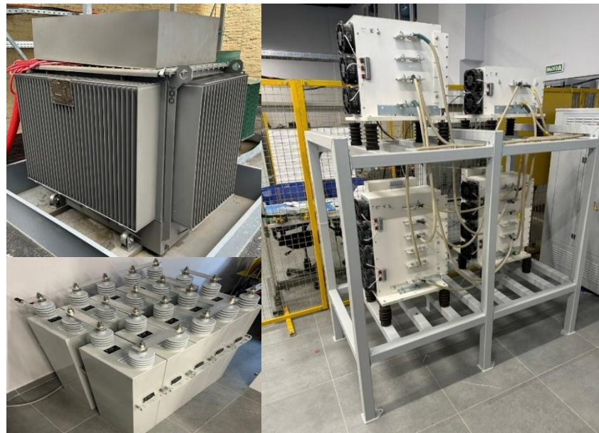
Опытный образец ПРРМ, состоящий из многообмоточного трансформатора, полупроводникового коммутатора и реактивного элемента
