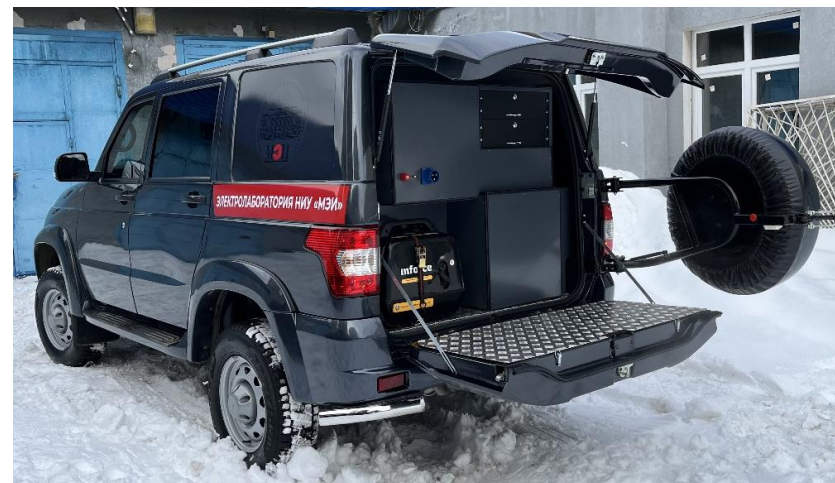
Внешний вид малогабаритной передвижной электроработатории для автоматизации поиска мест повреждений высоковольтных кабельных линий
