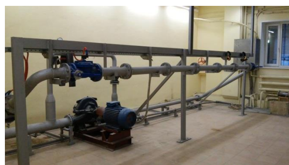
Рис. 8 – Экспериментальный стенд для исследования экспериментального образца устройства защиты трубопровода от динамических нагрузок на несжимаемых средах
