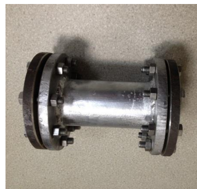
Рис. 7 – Устройство защиты трубопровода от гидравлического удара: 1 – основной трубопровод системы; 2 – фланцы; 3 – отрезок трубы; 4 – упругая вставка
