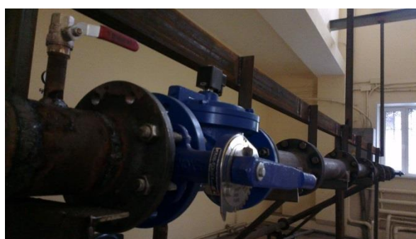
Рис. 8 – Экспериментальный стенд для исследования экспериментального образца устройства защиты трубопровода от динамических нагрузок на несжимаемых средах
