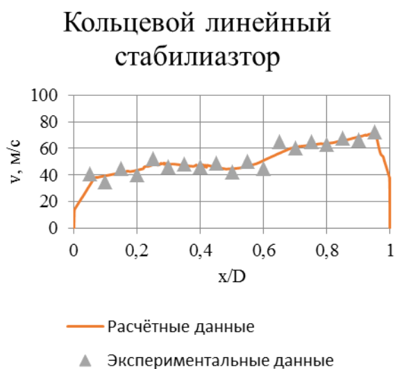
Рис. 6 – Сравнение расчётных и экспериментальных данных об эффективности кольцевого линейного стабилизатора
