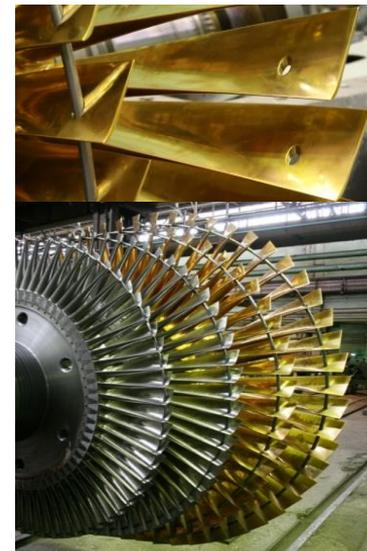
*Ионно-плазменное покрытие на лопатках паровой турбины*
