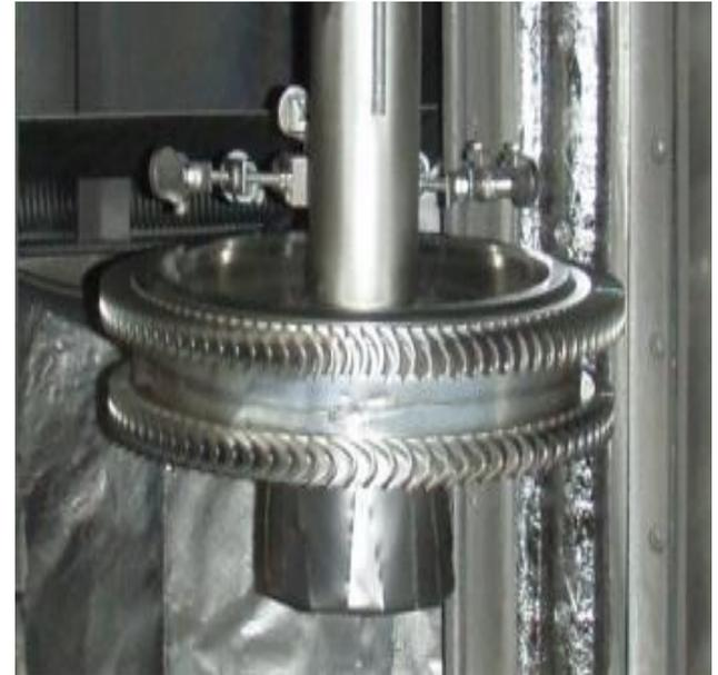
Фотоснимок диска Кертиса с жаростойким покрытием
