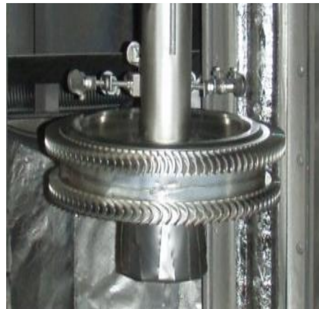
Фотоснимок диска Кертиса с жаростойким покрытием
