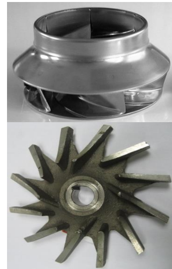
Рабочие органы насосного оборудования с износостойким покрытием
