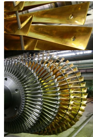
Ионно-плазменное покрытие на лопатках паровой турбины
