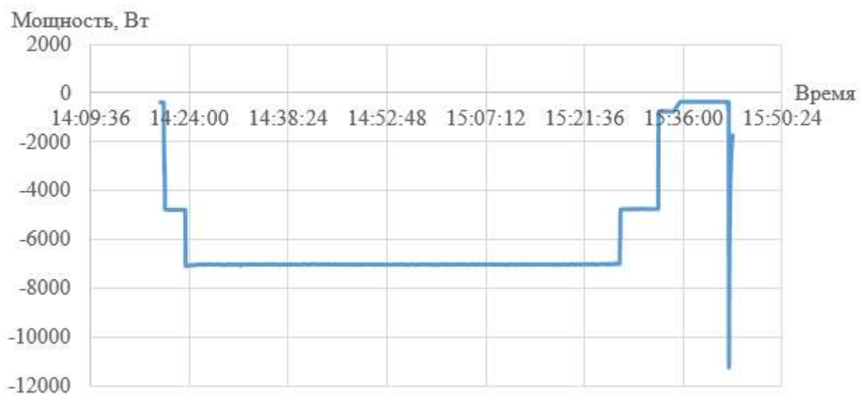
Рисунок 11 – Изменение разрядной мощности СНЭ при нагрузке 7 кВт
