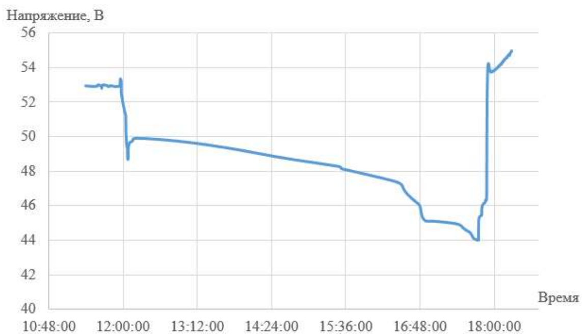
Рисунок 2 – Изменение разрядного напряжения на клеммах СНЭ при нагрузке 2 кВт
