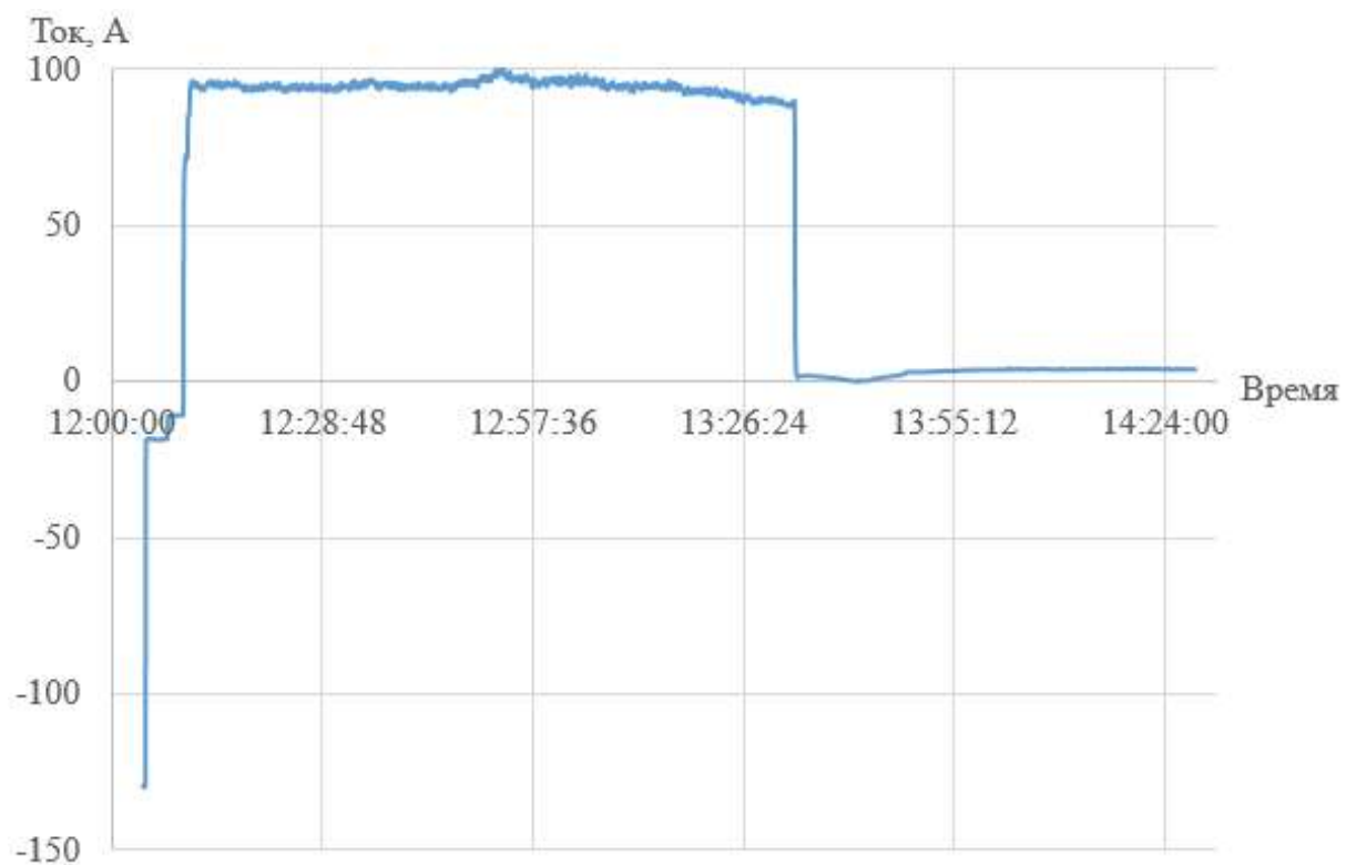
Рисунок 21 – Изменение зарядного тока на клеммах СНЭ при мощности 5 кВт
