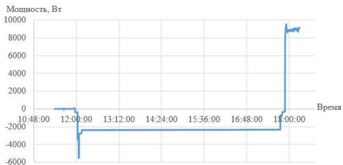
Рисунок 3 – Изменение разрядной мощности СНЭ при нагрузке 2 кВт
