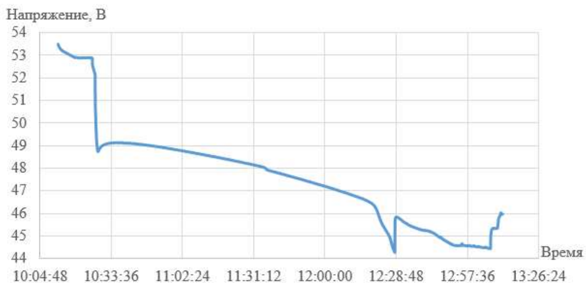
Рисунок 6 – Изменение разрядного напряжения на клеммах СНЭ при нагрузке 5 кВт
