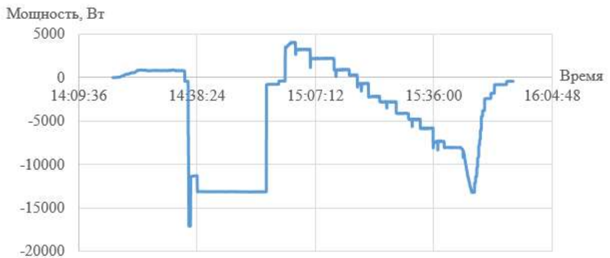
Рисунок 15 – Изменение разрядной мощности СНЭ при нагрузке 13 кВт
