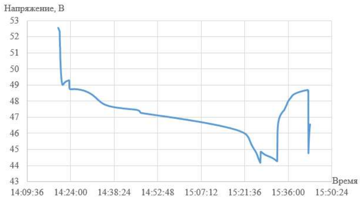
Рисунок 10 – Изменение разрядного напряжения на клеммах СНЭ при нагрузке 7 кВт
