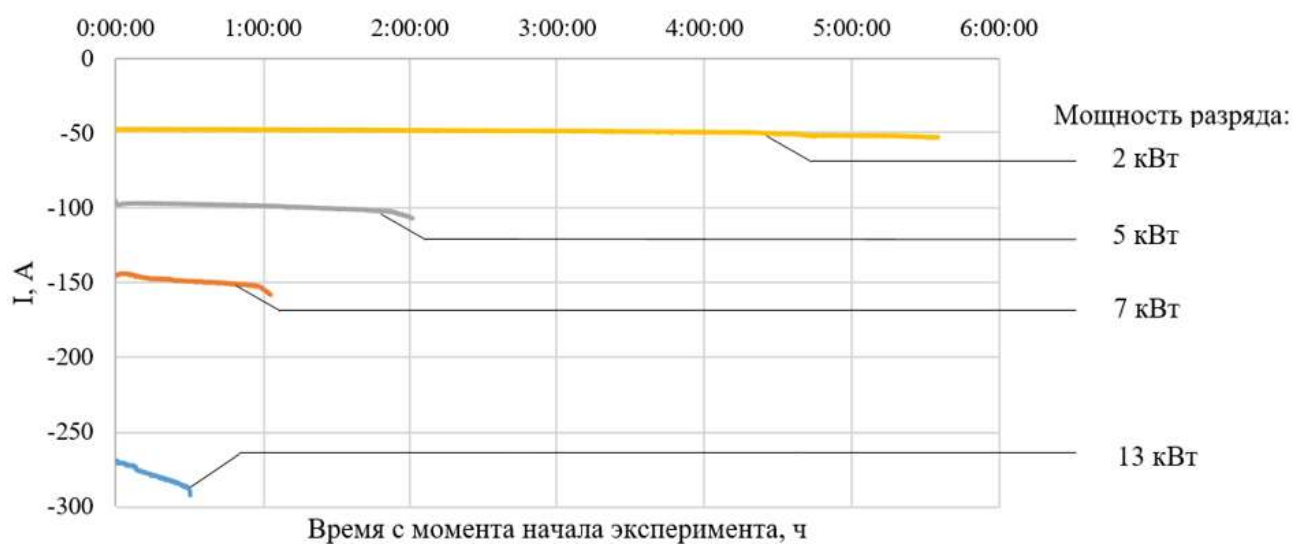
Рисунок 21 – Ток разряда АКБ
