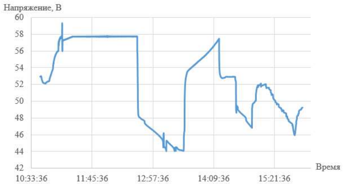
Рисунок 14 – Изменение разрядного напряжения на клеммах СНЭ при нагрузке 13 кВт
