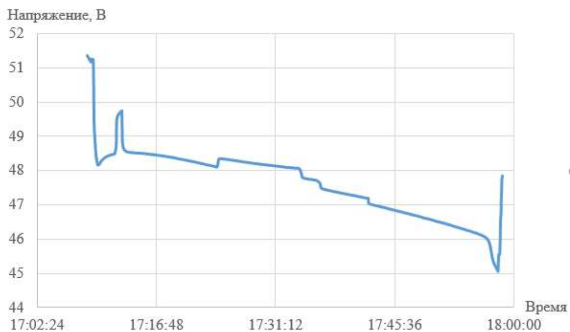
Рисунок 6 – Изменение разрядного напряжения на клеммах СНЭ
