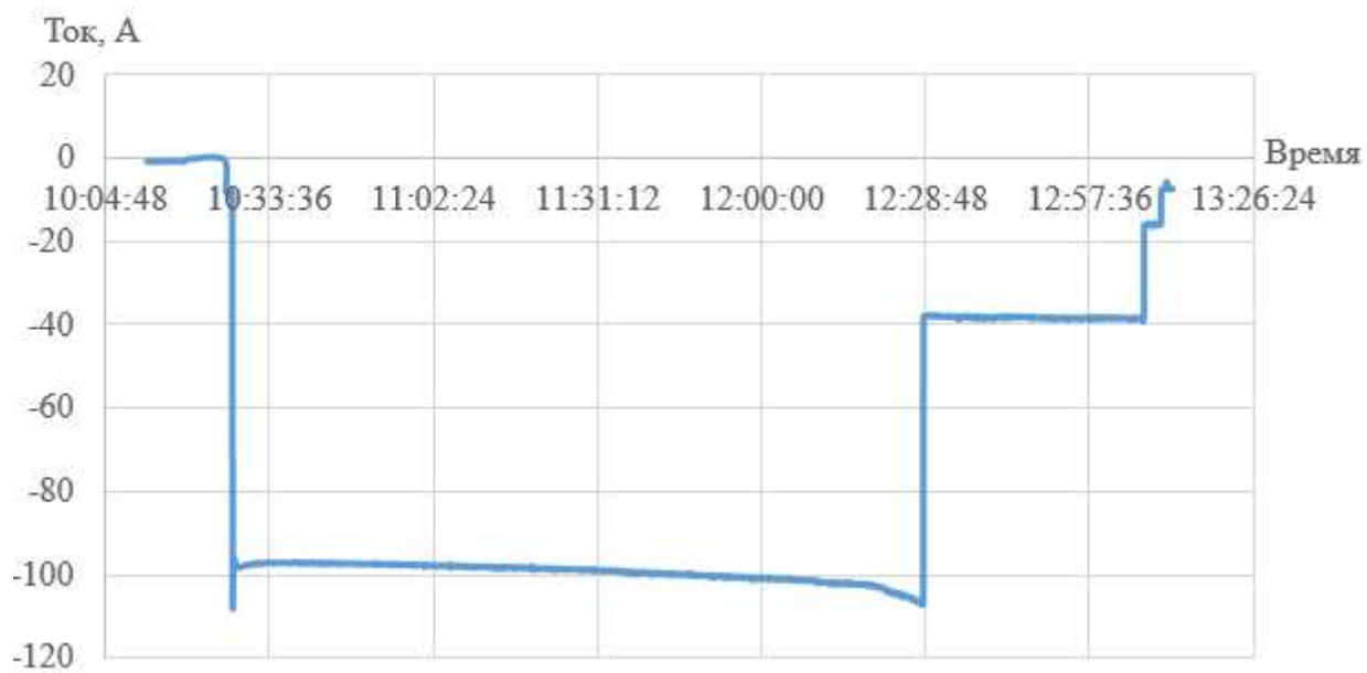
Рисунок 5 – Изменение разрядного тока на клеммах СНЭ при нагрузке 5 кВт
