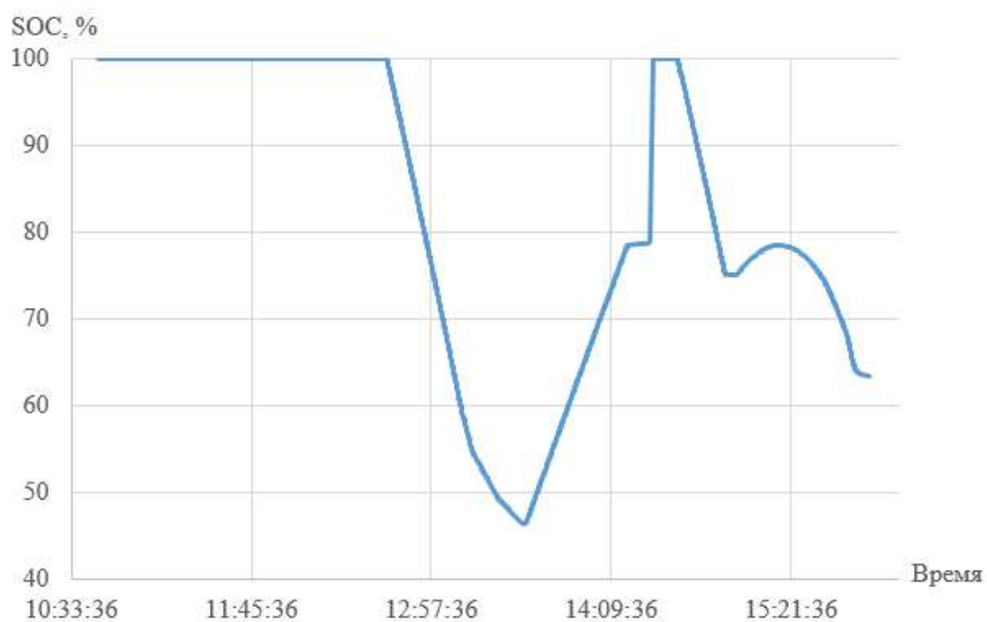
Рисунок 16 – Изменение показателя заряда СНЭ при нагрузке 13 кВт
