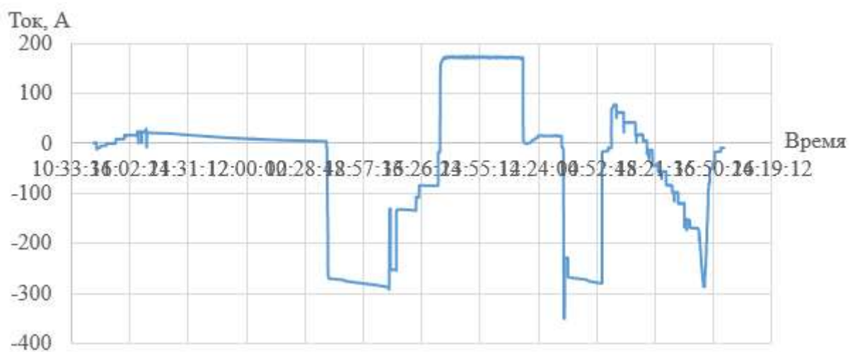
Рисунок 13 – Изменение разрядного тока на клеммах СНЭ при нагрузке 13 кВт
