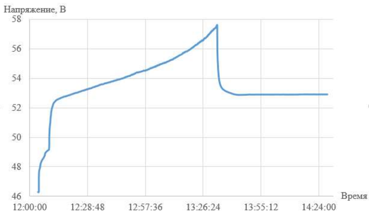
Рисунок 22 – Изменение зарядного напряжения на клеммах СНЭ при мощности 5 кВт
