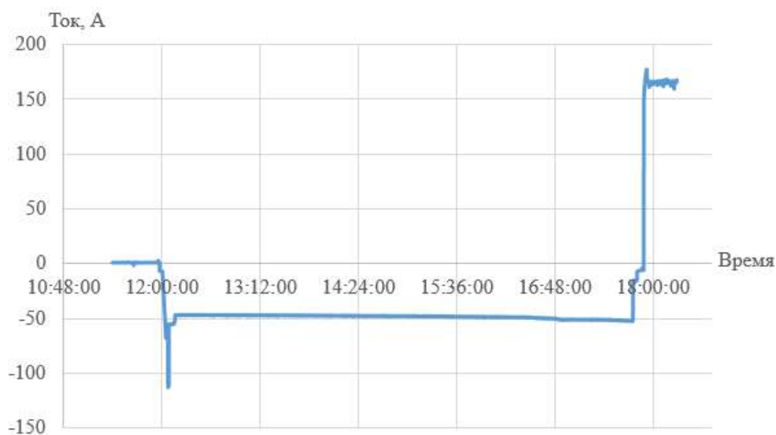
Рисунок 1 – Изменение разрядного тока на клеммах СНЭ при нагрузке 2 кВт
