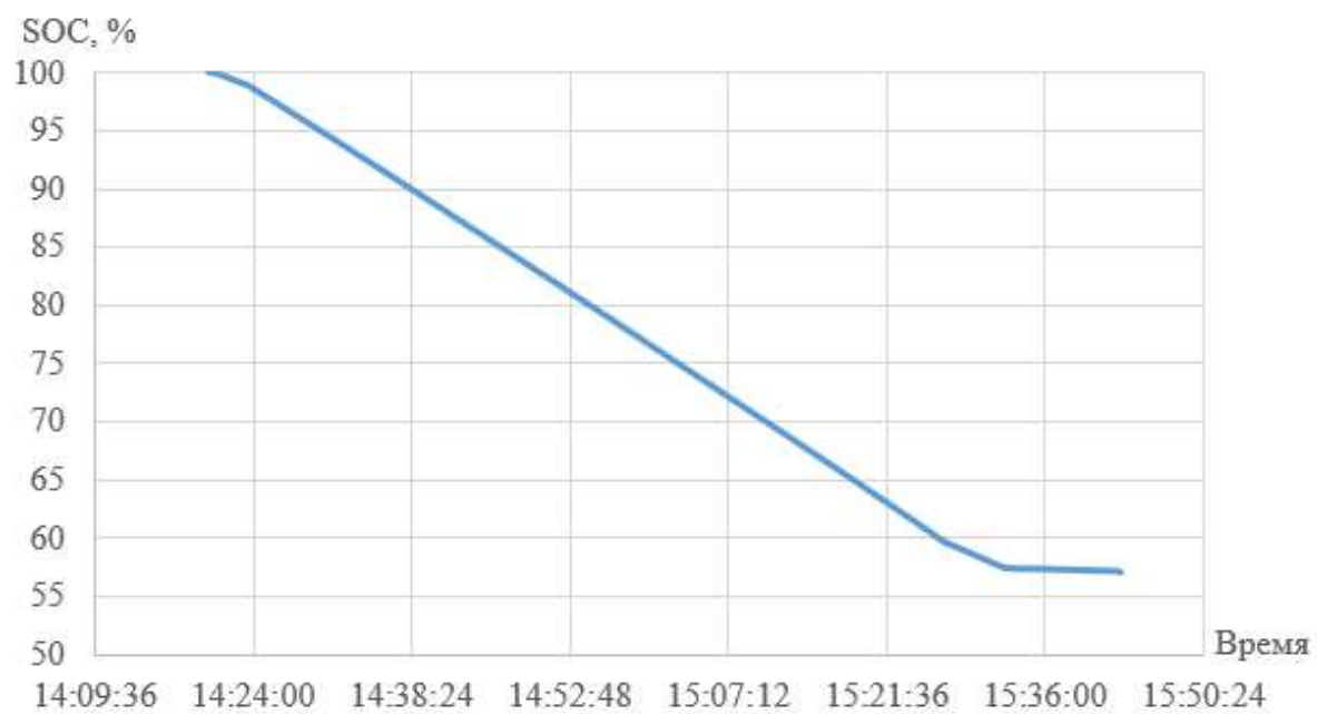
Рисунок 12 – Изменение показателя заряда СНЭ при нагрузке 7 кВт
