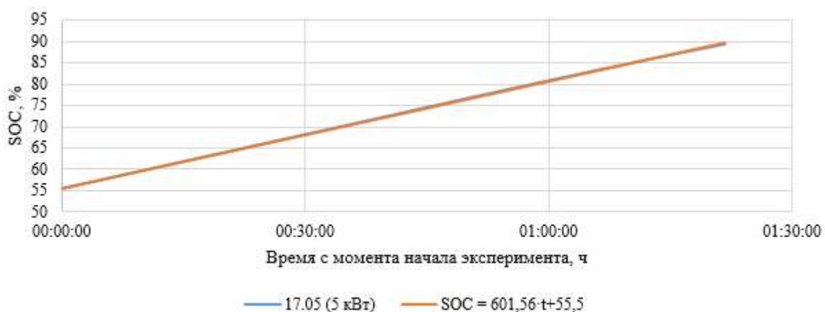
Рисунок 35 – Заряд СНЭ при 5 кВт
