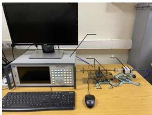
Рисунок 3 – Внешний вид установки для измерения электрических параметров сильно поглощающих диэлектриков квазиоптическим методом
