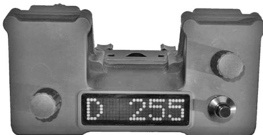
Перед вами пульт управления, он, по сути дела, является и передатчиком. На этом пульте выставляется вручную расстояние на котором должна подрываться граната, при отсутствии программирования подрыв гранаты осуществляется контактным способом. Дистанция до цели может определяться любым доступным способом, хоть на глаз. После вылета гранаты из канала ствола и ее активации, происходит запись параметров установки таймера на гранату с использованием радиочастотного метода.
