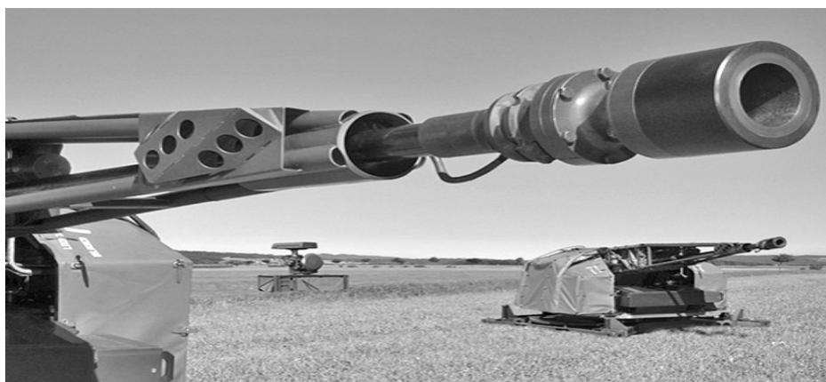
Программатор являлся отличительной особенностью установок с «умной системой воздушного подрыва боеприпасов». Он предназначался для дистанционного индуктивного программирования боеприпасов калибра 30–35 мм. Первоначально разработки велись в калибре 35 мм.
