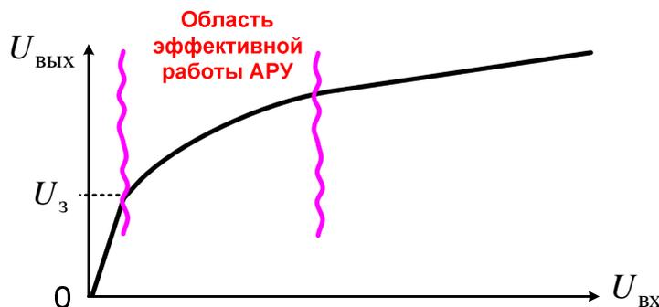
**Рис. 7.8. Построенная амплитудная характеристика**
