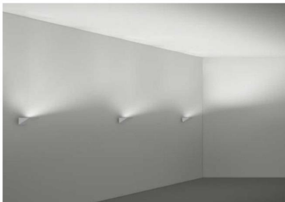
Рисунок 26 – Световой эффект при использовании светильников типа uplighter
