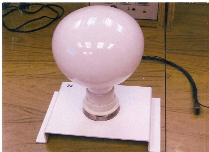
Рис 2.9 Общий вид БИЛЛ рефлекторного типа, Everlight 150 (ЭПРА не показан).
