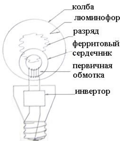
Рис. 2.3. Внешний вид лампы Андерсона [4].
