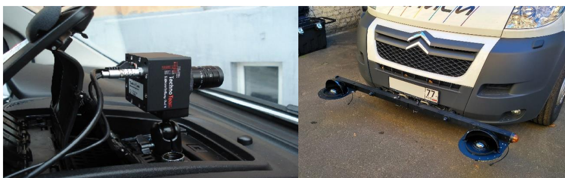
Рис. 10. Мобильная светотехническая лаборатория ВНИСИ. Яркомер установленный в кабине машины. Фотодатчики освещенности установленные на кузове машины [21]
