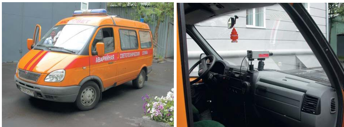
Рис. 6. Светотехническая мобильная лаборатория. Яркометр расположенный внутри кабины автомобиля
