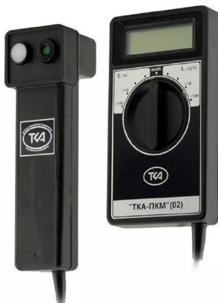
Рис 30. Изображение люксметра “ТКА-ПКМ”/02, используемого для проведения расчетов освещенности.
