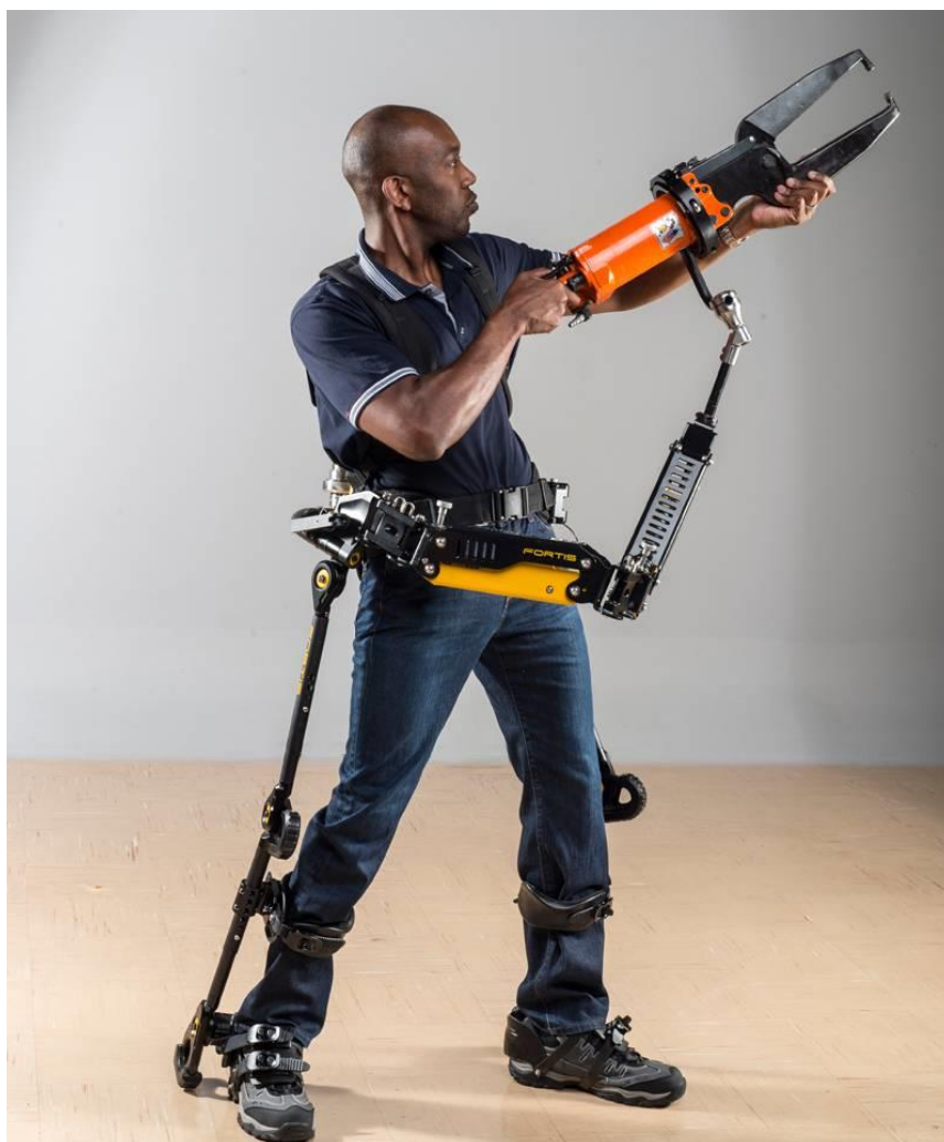
Рис. 7. Промышленный экзоскелет для работ в чрезвычайных ситуациях, например, разбор завалов
