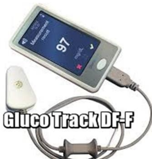
Рис. 2. Неинвазивный глюкометр GlucoTrack DF-F
