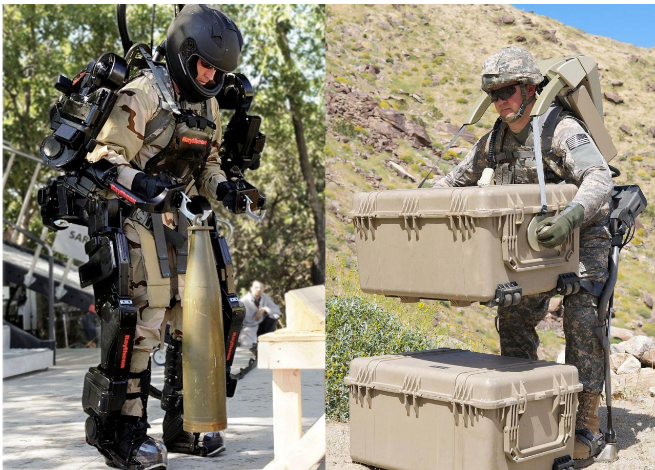
Рис. 10. Военный экзоскелет для увеличения возможности переноски тяжелых грузов
