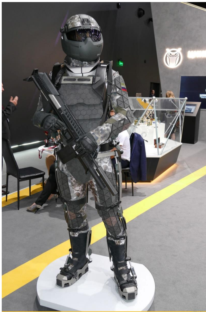
Рис. 11. Военный экзоскелет для использования тяжелого оружия без станков
