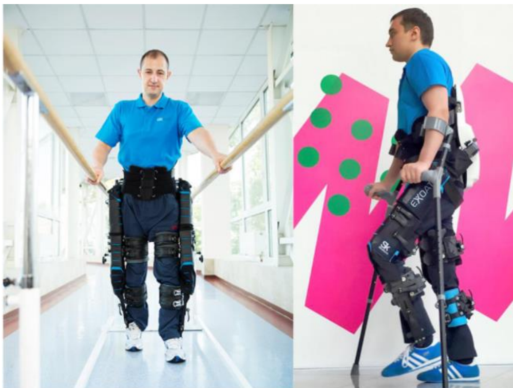
Рисунок 7 – Применение экзоскелетов для восстановления работы ног
