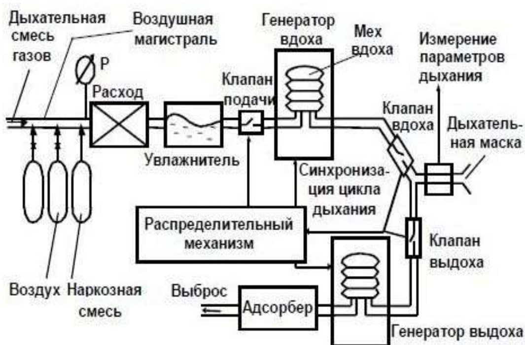
Рисунок 11 – Схематическое изображение аппарата ИВЛ
