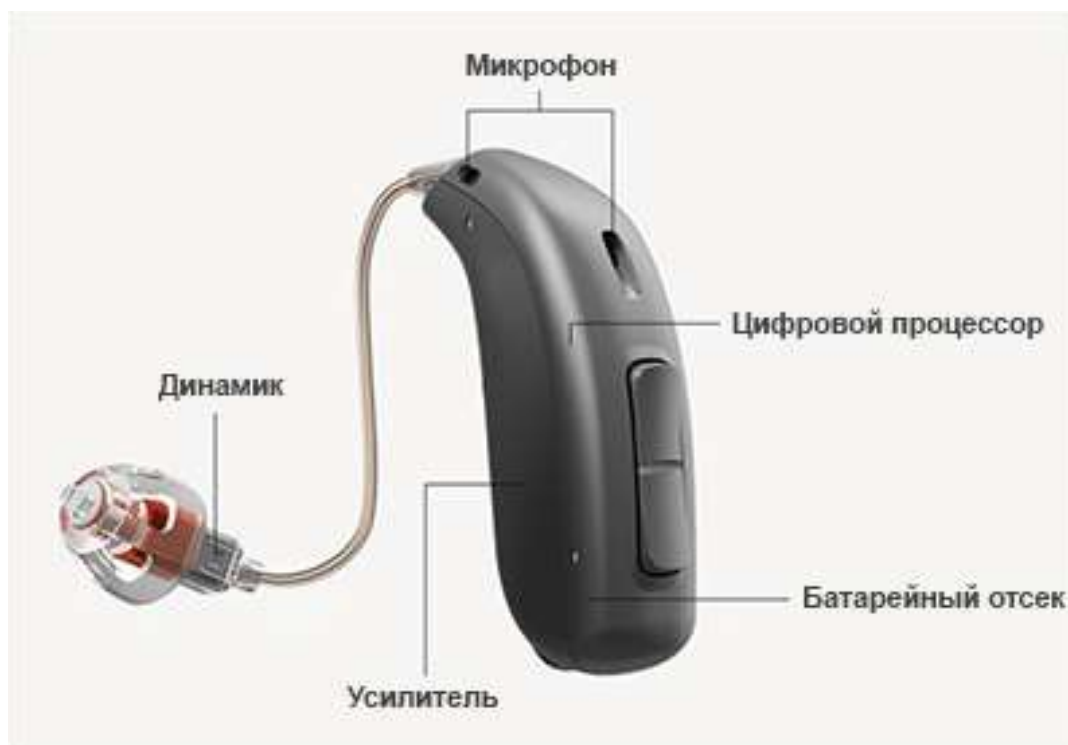
Рисунок 14 – Строение цифрового слухового аппарата
