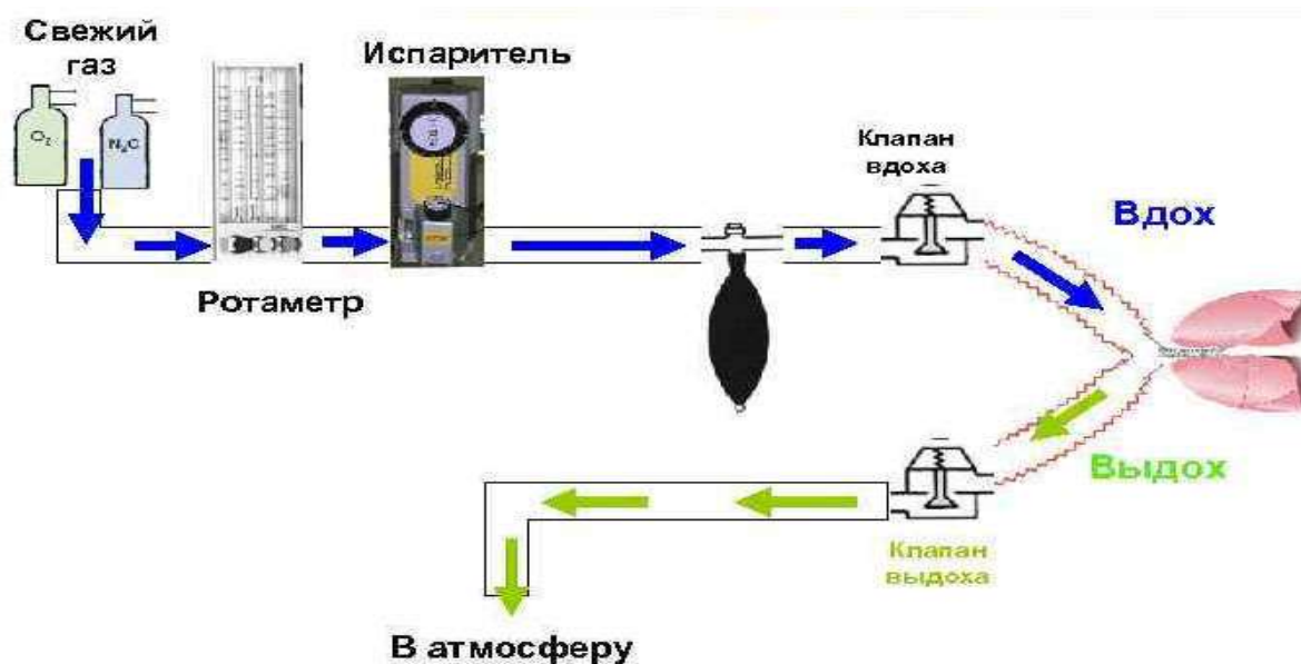
Рисунок 6 - Полуоткрытый неревверсивный дыхательный контур
