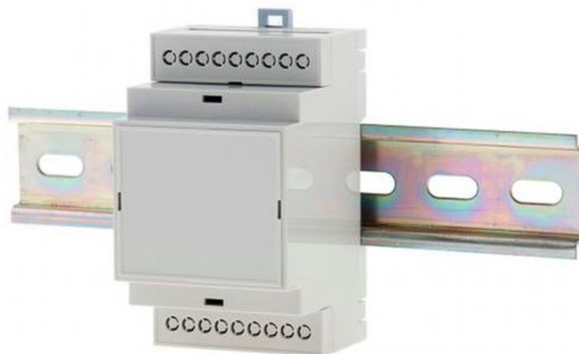
Рисунок 21 – Прототип оконечного устройства: вид корпуса устройства
