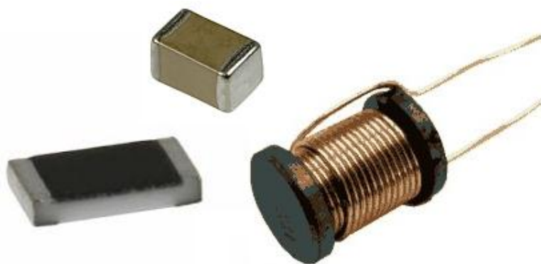
Рис. 1.3. Резистор, конденсатор и катушка моделируемой цепи
