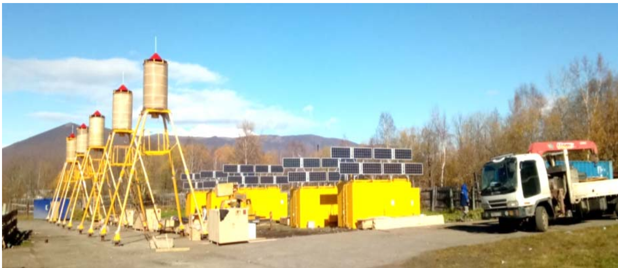
Рис. 2. Серийные солнечные ветроэлектрические установки на площадке промежуточной сборки на Камчатке в 2017 г.
