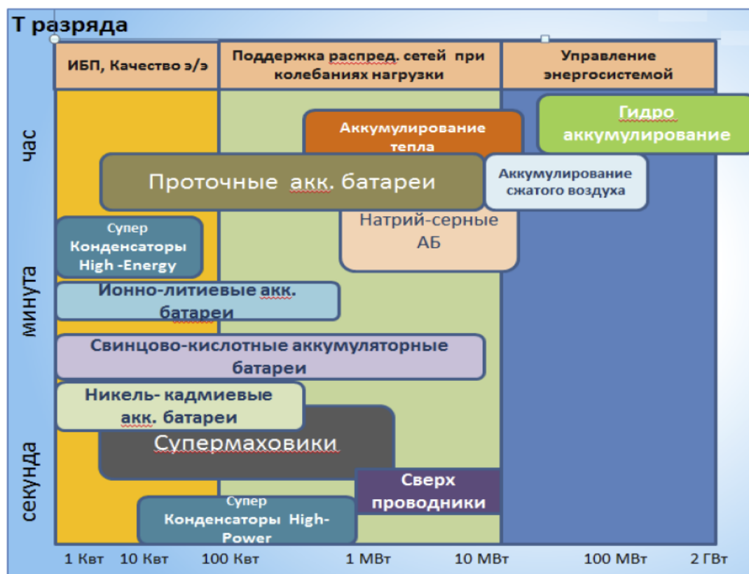
Рис. 1 Возможности использования различных технологий накопления энергии в энергетике в соответствии с их характеристиками
