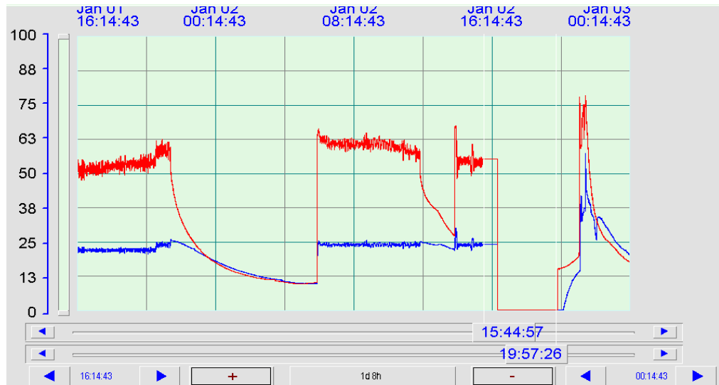
Рис. 1.6. Тренды изменения температуры воды и воздуха ПВУ здания во время аварийной ситуации
