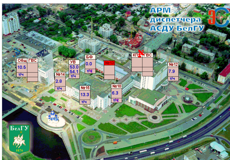
Рис. 2.5. Интерфейс АРМ оператора АСДУ распределенными энергоресурсами НИУ БелГУ
