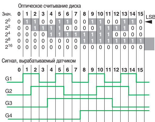
↑ Рис. 52 Сигнал, выработанный в коде Грея вращающимся абсолютным энкодером
