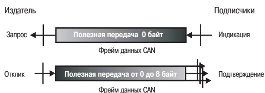
↑ Рис. 19 Модель CAN «издатель/подписчик» (выталкивание / вталкивание данных)
