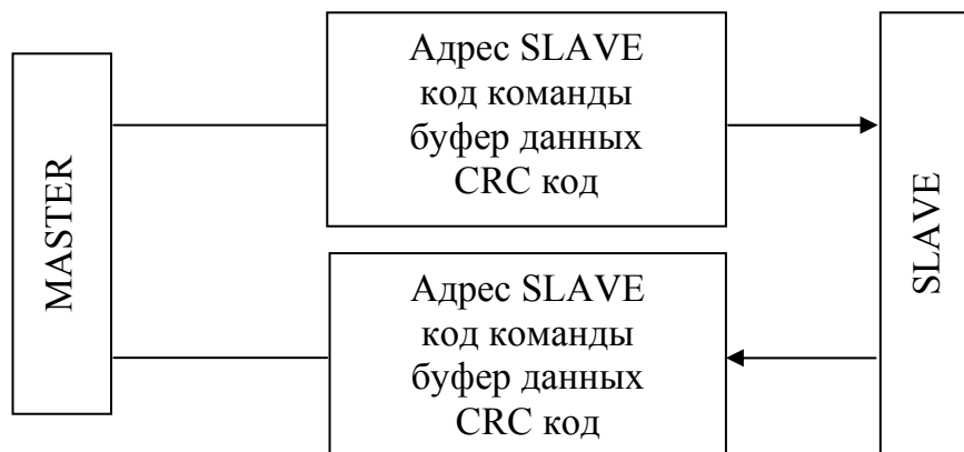
Рис. 5.10. Общая схема работы сети MODBUS
