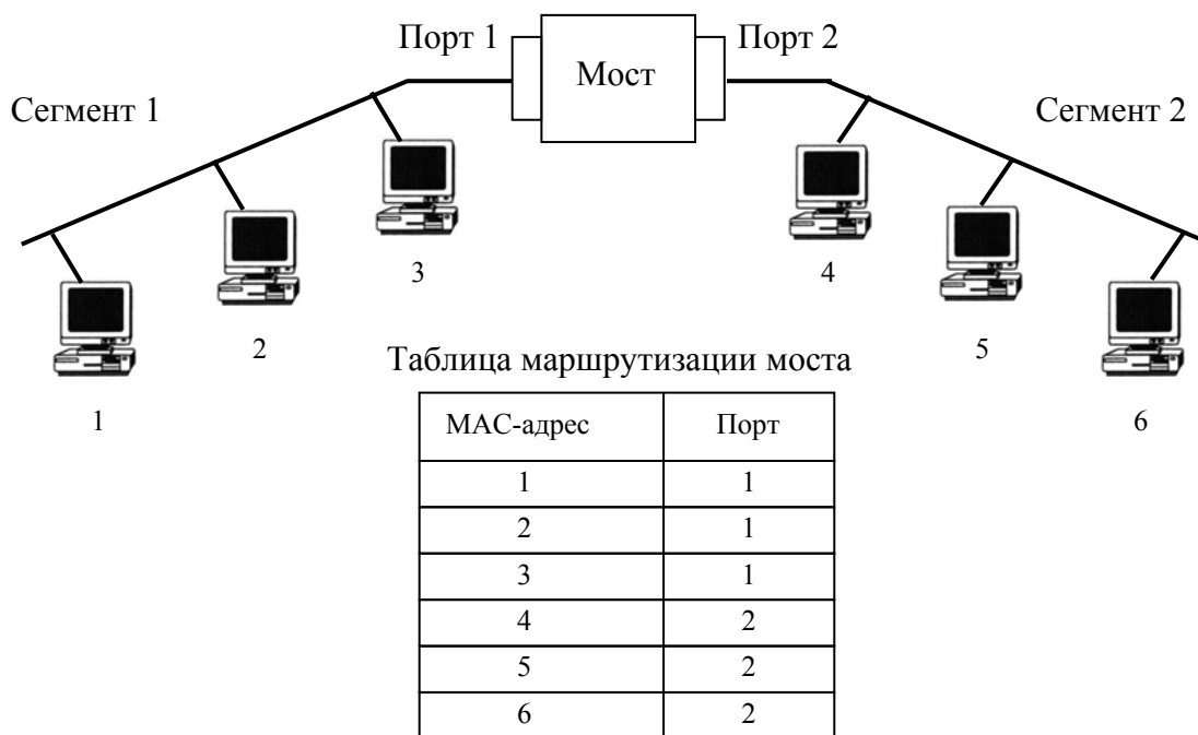
Рис. 4.28. Принцип работы моста
