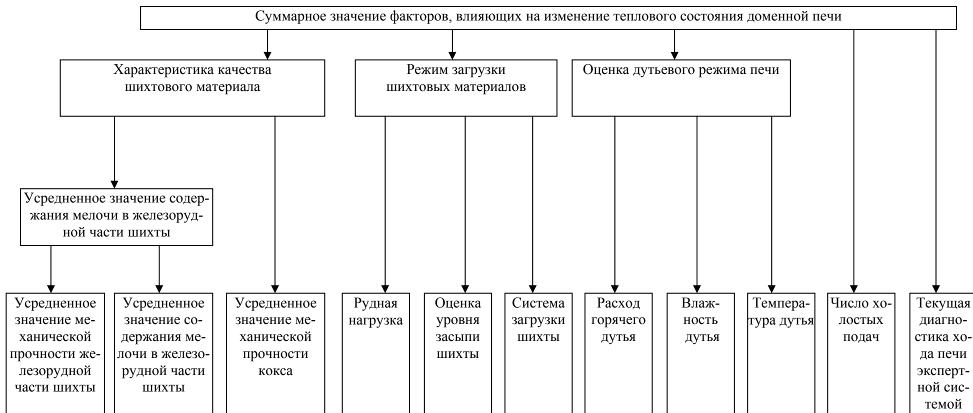
Рис. 8.10. Схема базы знаний причин тепловых расстройств доменной печи
