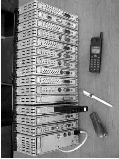
Рис. 1.7. Модульная система МСТС производства ПК «Пролог», Россия ставить несколько комбинаций процессорного ядра и разных силовых плат без необходимости корректировки программного обеспечения. При необходимости процессор можно заменить даже в готовой системе.
