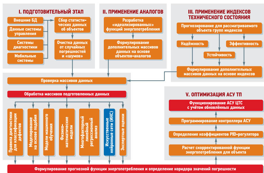
Рис. 1. Блок-схема алгоритма повышения точности автоматизированной системы управления технологическим процессом посредством применения прогнозных функций энергопотребления
