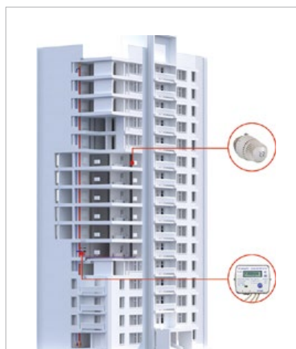
Рис. 3. Новый многоквартирный дом с централизованным отоплением, в котором на вводе установлен узел учёта и регулирования тепловой энергии, а во всех квартирах смонтированы ИПУ тепловой энергии и термостатические регуляторы на отопительных приборах
