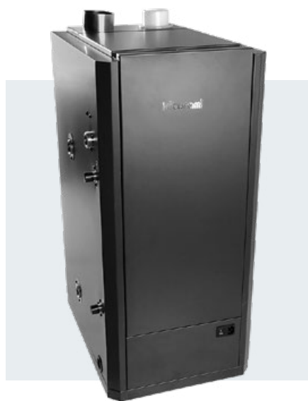
❖ Напольный газовый двухконтурный котёл Kiturami STSG-47 с наддувной горелкой с предварительным смешиванием газа и воздуха и принудительной циркуляцией теплоносителя
