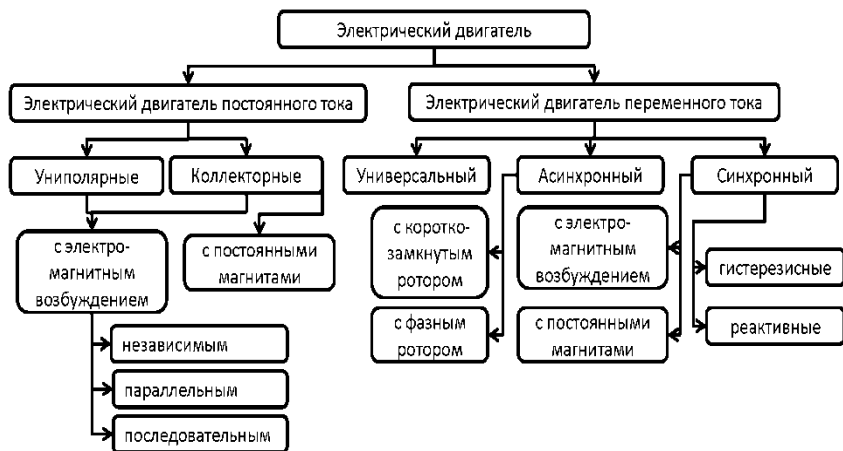
Рис. 2. Классификация электрических двигателей
