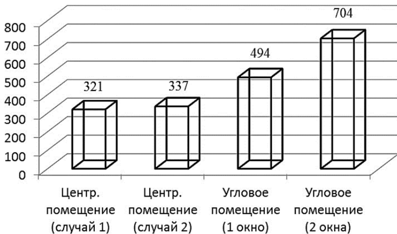
Рис. 4.3. Суммарные потери тепла через НОК, Вт
