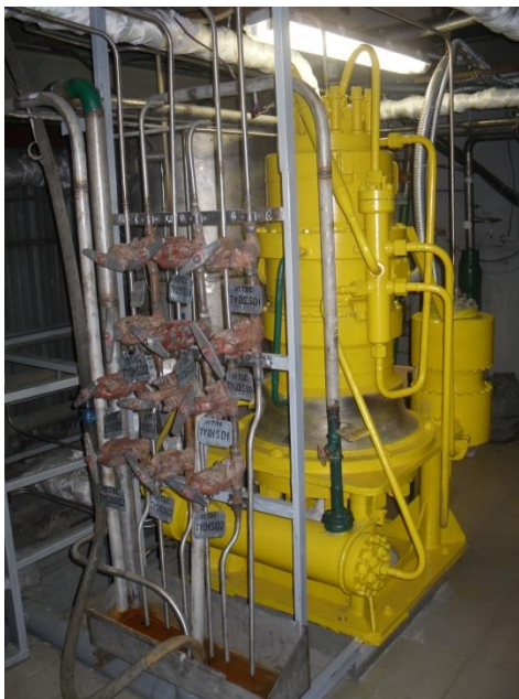
Фрагменты стенда ТВС МЭИ (центробежный насос гидравлического контура, стойка с датчиками измерения расхода и давления)
