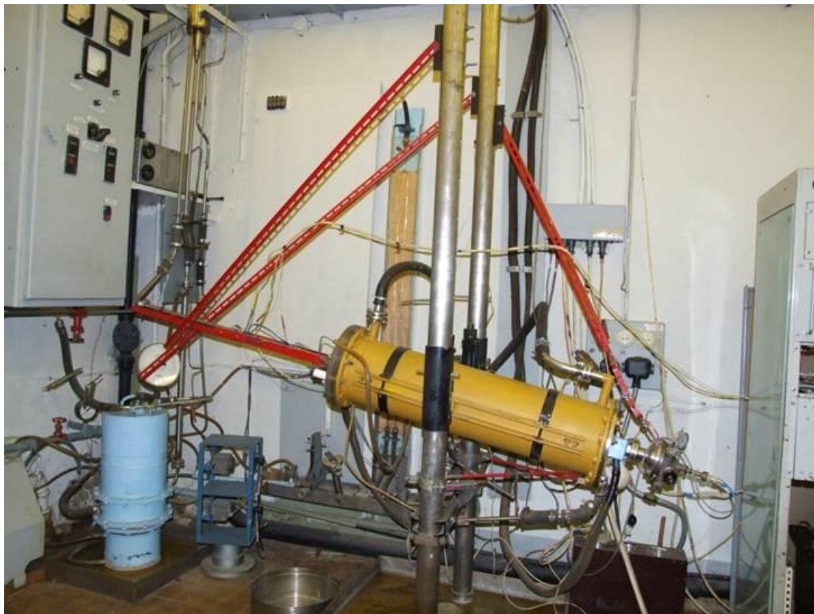
Уникальная научная установка УНУ «Ртутный МГД-стенд» - участок для исследования теплообмена и гидродинамики жидких металлов в продольном магнитном поле.
