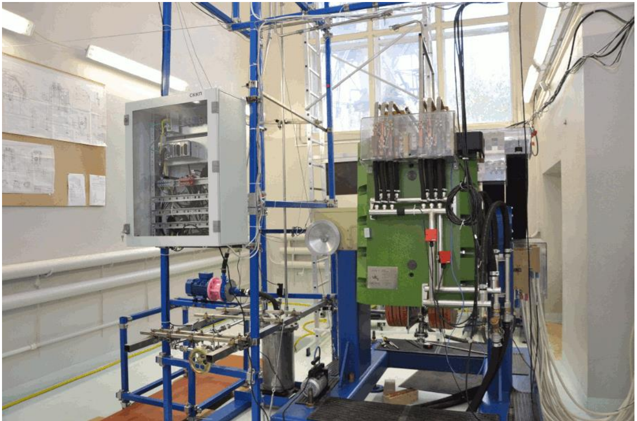
Уникальная научная установка УНУ «Ртутный МГД-стенд» - участок для исследования теплообмена и гидродинамики жидких металлов и расплавов солей в расширенном диапазоне параметров в магнитном поле
