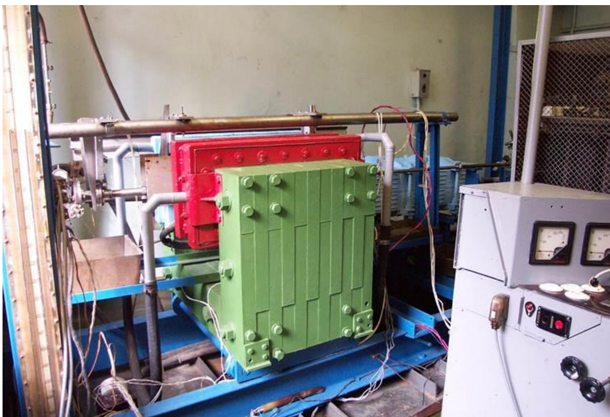
Уникальная научная установка УНУ «Ртутный МГД-стенд» - участок для исследования теплообмена и гидродинамики жидких металлов в поперечном магнитном поле
