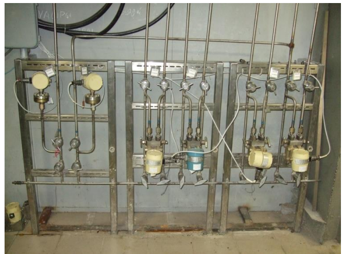
Фрагменты стенда ТВС МЭИ (центробежный насос гидравлического контура, стойка с датчиками измерения расхода и давления)
