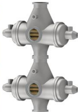
Фотоснимок и 3D модель лабораторного образца теплообменного аппарата
