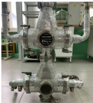
Фотоснимок и 3D модель лабораторного образца теплообменного аппарата
