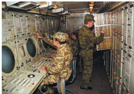
В кабине передвижного Командного пункта полка С-300 ПМУ. ЭВМ - 40У6, приемник 5Э26
