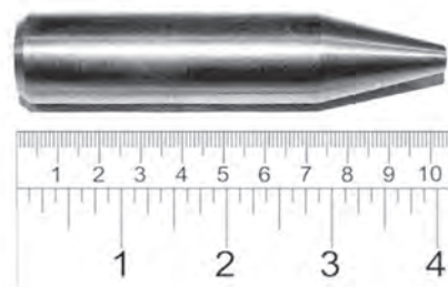
Сердечник снаряда калибром 30 мм из обедненного урана deploymentlink.osd.mil
