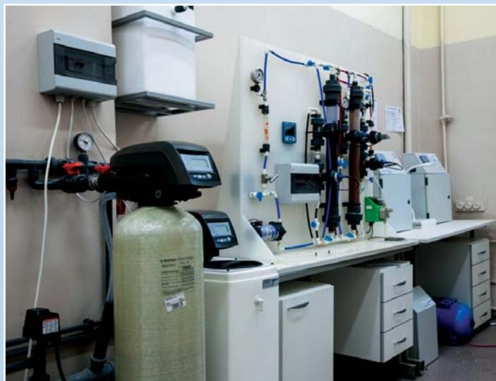
Экспериментально-обучающий стенд для моделирования современной водоподготовительной установки (ТОТ)
