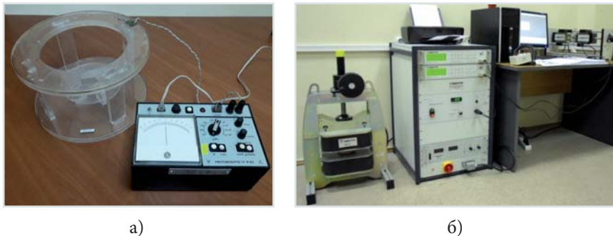
Рис. 4. Установки для контроля магнитных материалов: а) кольца Гельмгольца; б) программно-аппаратный комплекс для контроля постоянных магнитов и магнитомягких материалов Permagraf/ Remagraph
