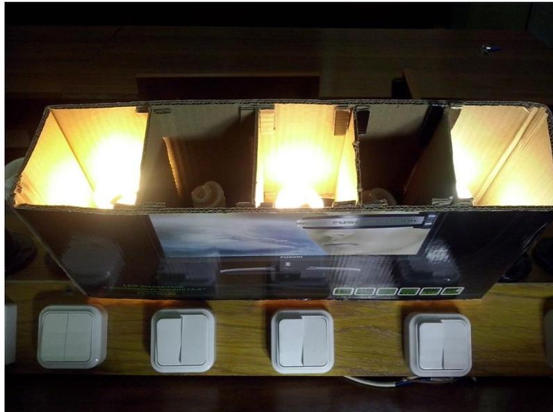
Рис. 3.11. Внешний вид установки со светоограничительным устройством для повышения ее разрешающей способности
