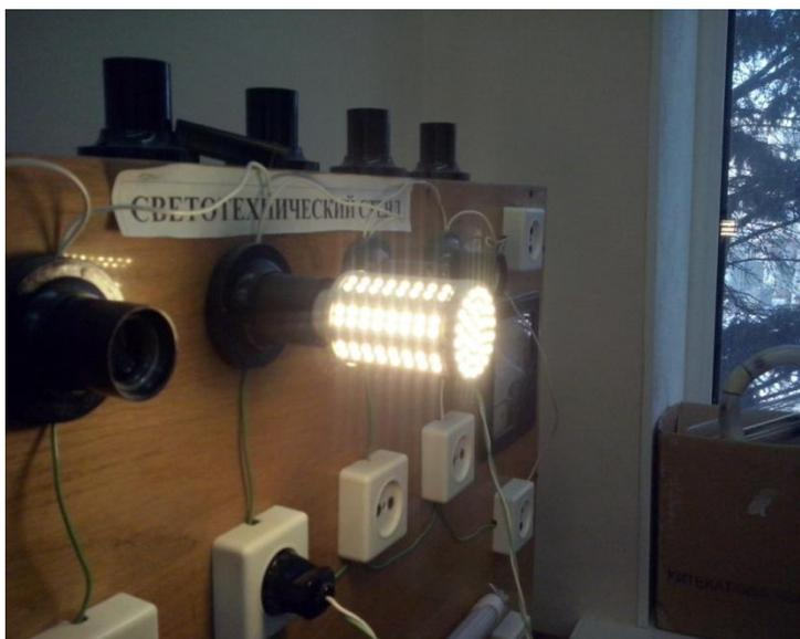
Рис. 3.2. Внешний вид светодиодной лампы SY-A-K-164W типа «corn» (кукуруза)
