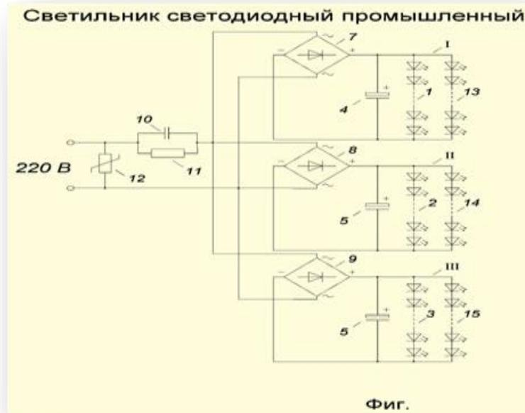
Рис. 3.14. Принципиальная электрическая схема мощного трехблочного светодиодного промышленного светильника
