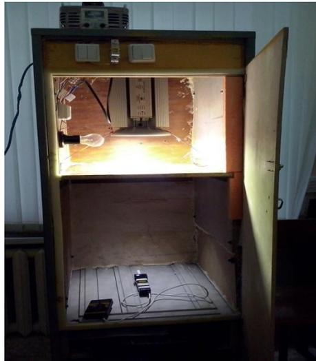
Рис. 3.13. Конструкция термокамеры для испытания промышленных светодиодных светильников с открытой дверцей
