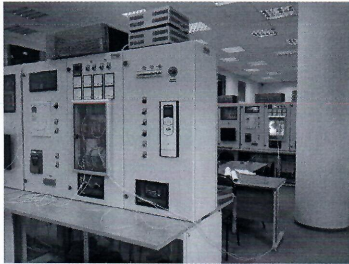
Рис. 7. Лабораторная установка для определения параметров тепловой модели электродвигателя с датчиком в лобовой части обмотки
