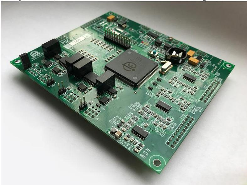
Рис. 26. Контроллер МК40.4, применённый в тяговом приводе БЕЛАЗ-90
