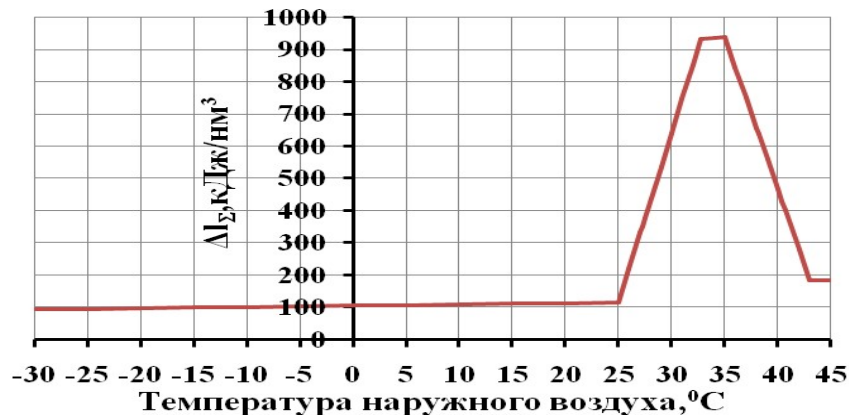
Рис.4. Зависимость величины приращения суммарной удельной полезной работы от температуры наружного воздуха для схемы с ДГА без подогрева газа при начальном давлении 7 атм и доли поступающего в ДВС топлива g=1 .
