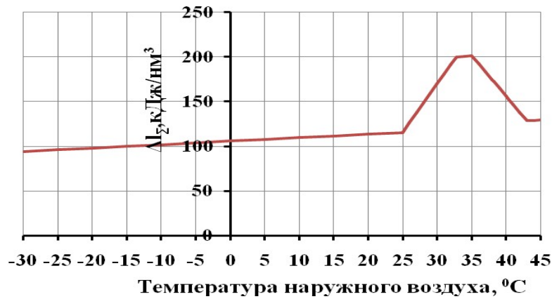
Рис.3. Зависимость величины приращения суммарной удельной полезной работы от температуры наружного воздуха для схемы с ДГА без подогрева газа при начальном давлении 7 атм и доли поступающего в ДВС топлива g=0,1 .
