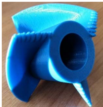
Рис. 14. Рабочее колесо с лопастной системой, усовершенствованной с использованием природободобных технологий
