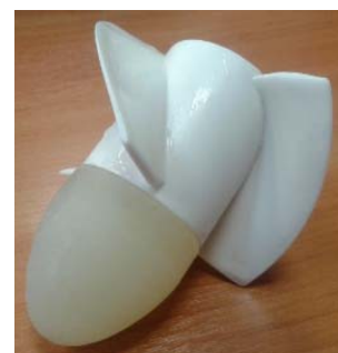
Рис. 9. Рабочее колесо, спроектированное с использованием классических подходов.
