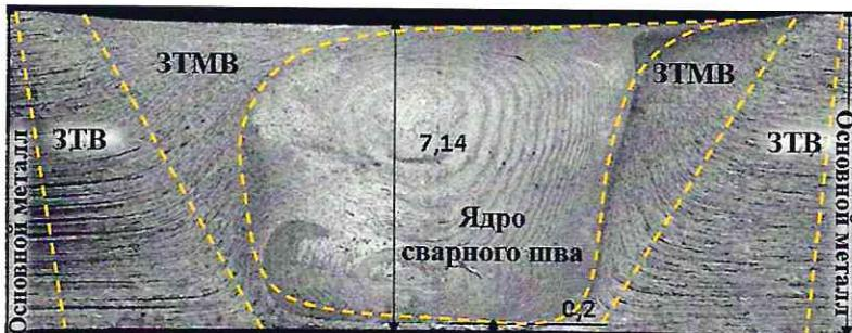
Рис. 2 Схема расположения структурных зон стыкового соединения СТП
