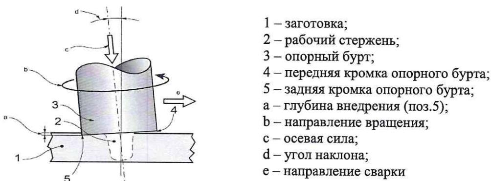
Рис. 1 Схема положения сварочного инструмента при СТП
