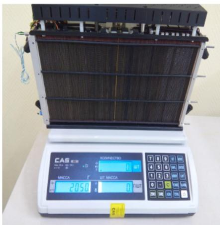
Рисунок 17 – БТЭ с прямой подачей воздуха «VM Power», состоящая из 144 топливных элементов, пиковая мощность 2 кВт
