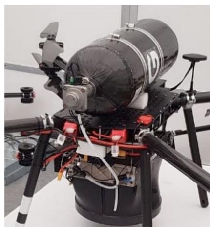
Рисунок 18 – Энергосистема 2 кВт на квадрокоптере
