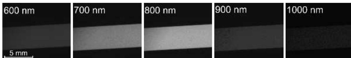
Рис. 5. Примеры зарегистрированных спектральных изображений вольфрамовой пластины при постоянном токе 15 А и времени накопления 0,5 с
